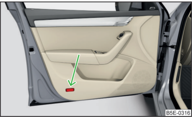
Fig. 57 Front door warning light
