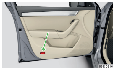
Fig. 62 Front door warning light
