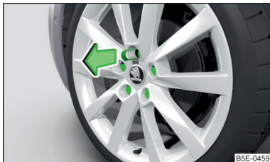
Fig. 328 Remove the cap
