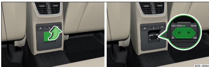
Fig. 115 Open the cover of the 230 volt outlet / 230 volt outlet
