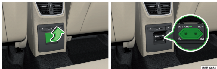
Fig. 118 Open the cover of the 230 volt outlet / 230 volt outlet
