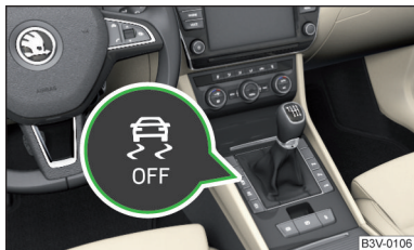
Fig. 175 Press the ESC system
