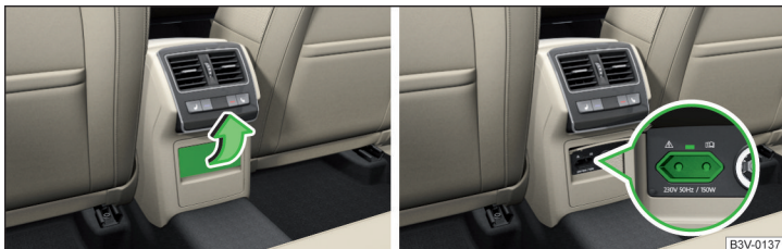
Fig. 116 Open the cover of the 230 volt outlet / 230 volt outlet
