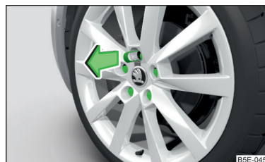
Fig. 243 Remove the cap
