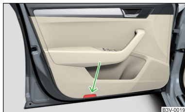
Fig. 64 Front door warning light
