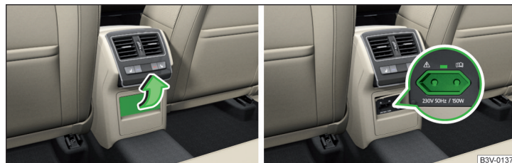
Fig. 132 Open the cover of the 230 volt outlet / 230 volt outlet
