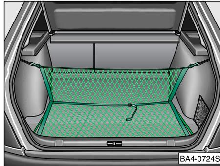
Voorbeeld van de bevestiging van een verticaal dubbelnet Octavia - zie afbeelding.
