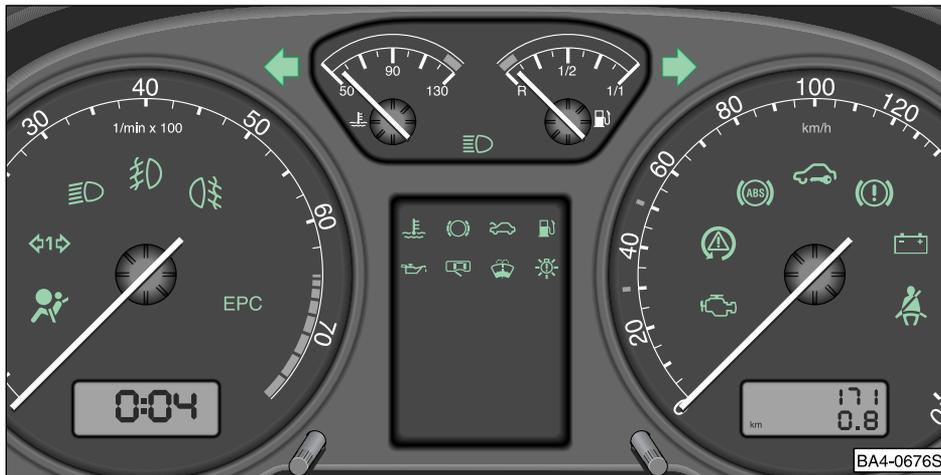
De plaatsing van de controlelampjes is afhankelijk van het model en het motortype. De in de hiernavolgende beschrijving afgebeelde symbolen zijn ook bij, resp. op de overeenkomstige controlelampjes aangebracht.
