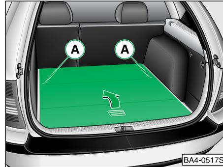
De verhoogde laadvloer vergemakkelijkt het laden en lossen van bagage met grote afmetingen. Dit kan als volgt worden uitgebouwd:
