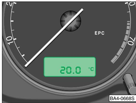
**Bij het aanzetten van het contact** wordt de functie ingeschakeld die vóór het uitzetten van het contact was gekozen. Als de buitentemperatuur ca. 0 °C bedraagt, wordt de buitentemperatuur met een symbool\* weergegeven.
