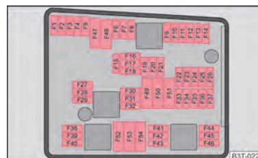
Afbeelding 200 Schematische weergave van de zekeringhouder in de motorruimte - uitvoering 1
