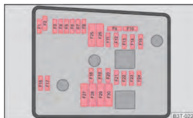
Afbeelding 201 Schematische weergave van de zekeringhouder in de motorruimte - uitvoering 2
