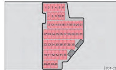
Afbeelding 202 Schematische weergave van de zekeringhouders in het dashboard
