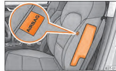
Afbeelding 148 Inbouwplaats van de zij-airbag in de bestuurdersstoel
