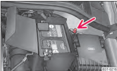
Afbeelding 194 Starthulp bij wagens met start-stopsysteem
