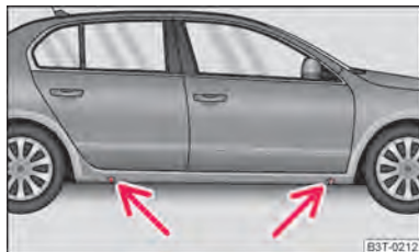
Afbeelding 189 Wiel verwisselen: Steunpunten voor de krik
