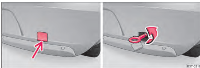
Afbeelding 197 Achterbumper: Verwijderen van de afdekking / montage van het sleepoog
