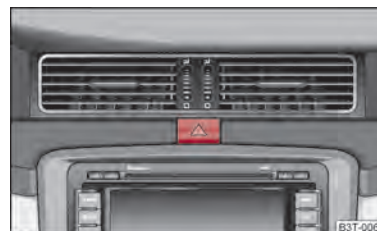
Afbeelding 39 Dashboard: schakelaar voor alarmlichten
