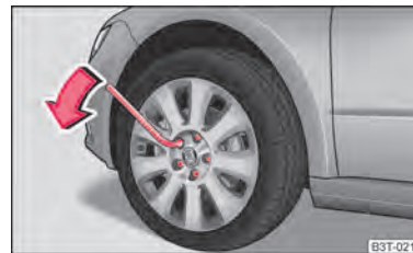
Afbeelding 188 Wiel verwisselen: Wielbouts een slag losdraaien
