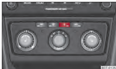
Afbeelding 112 Toets voor rechtstreeks in- of uitschakelen van de extra verwarming (interieurvoorverwarming en -ventilatie) op het bedieningselement van de airconditioning
