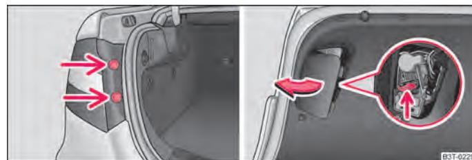
Afbeelding 207 Uitbouwen van het buitenste deel van de achterlichtunit / uitbouwen van het binnenste deel van de achterlichtunit
