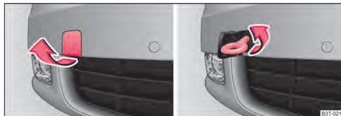
Afbeelding 196 Voorbumper: Verwijderen van de afdekking / montage van het sleepoog
