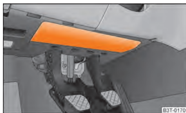
Afbeelding 147 Knie-airbag bestuurder onder de stuurkolom
