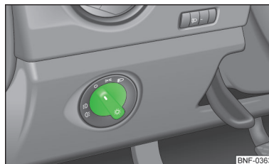
Fig. 22 Tabloul de bord: Comutatorul de lumini
