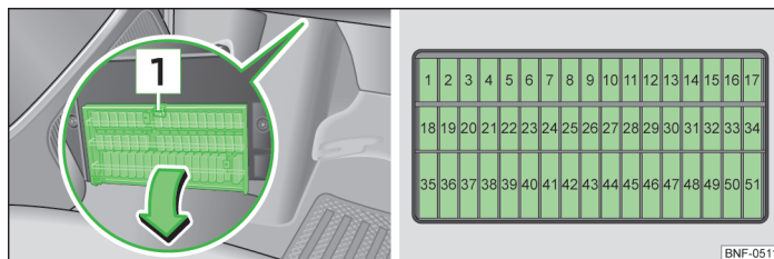
Fig. 124 Partea inferioară a planșei de bord: panoul de siguranțe / reprezentare schematică a panoului de siguranțe
