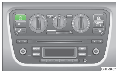
Fig. 81 Tasta pentru sistemul START-STOP
