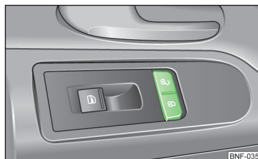
Fig. 15 Tasta de închidere centralizată
