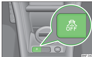
Fig. 83 Partea inferioară a consolei centrale: Tasta pentru sistemul City Safe Drive
