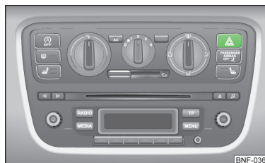
Fig. 26 Tabloul de bord: Comutator pentru luminile de avarie
