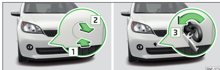
Fig. 127 Demontarea capacului / montarea cârligului de tractare
