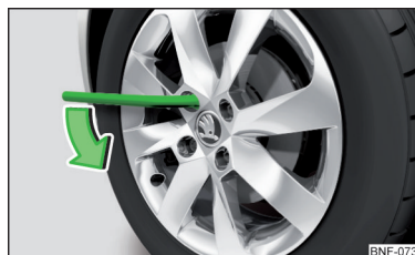
Fig. 121 Slăbirea șuruburilor de roată
