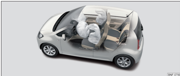
Fig. 7 Airbag umplut cu gaz
