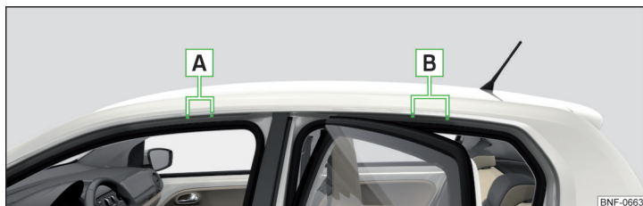
Fig. 80 Puncte de fixare - autovehicul cu 5 uși
