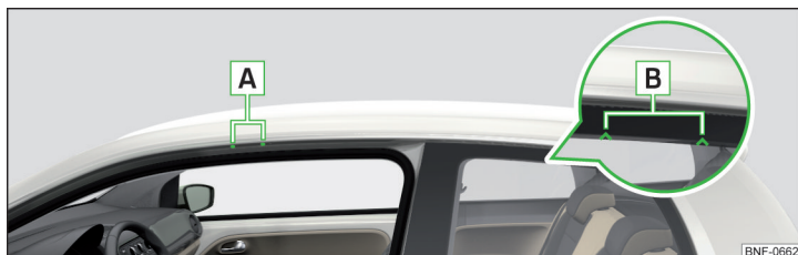
Fig. 79 Puncte de fixare - autovehicul cu 3 uși
