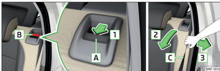
Fig. 50 Rabatarea spre înainte a spătarului / tragerea centurii spre capotaj lateral
