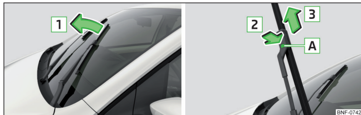
Fig. 132 Înlocuirea lamelei ștergătorului de parbriz
