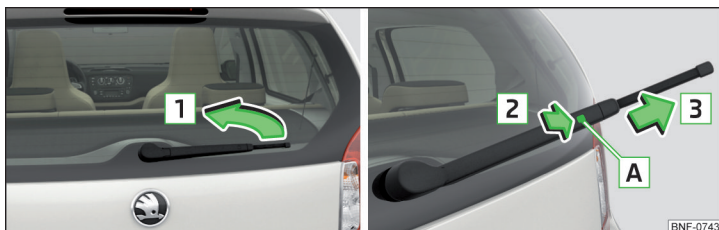
Fig. 133 Înlocuirea lamei ștergătorului de lunetă
