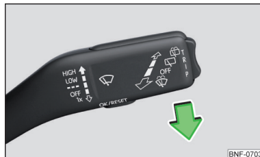
Fig. 131 Reglarea poziției de service a brațelor ștergătoarelor de parbriz
