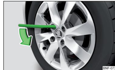
Fig. 153 Slăbirea șuruburilor de roată
