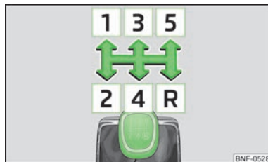
Fig. 65 Schema de selectare a treptelor cutiei de viteze manuale cu 5 trepte
