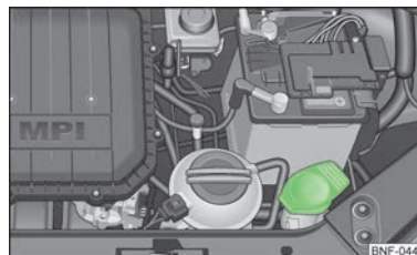
Fig. 103 Compartimentul motor: Rezervorul lichidului de spălare
