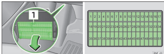
Fig. 119 Partea inferioară a planșei de bord: panou de siguranțe / reprezentare schematică a panoului de siguranțe
