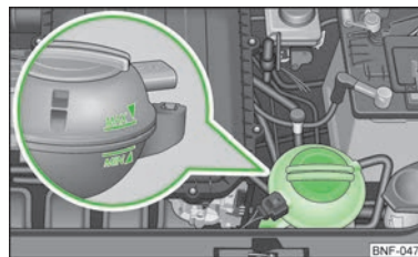
Fig. 101 Compartimentul motor: vasul de expansiune al lichidului de răcire
