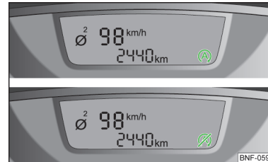
Fig. 87 Sus: Motorul este oprit automat / Jos: oprirea automată a motorului nu este posibilă
