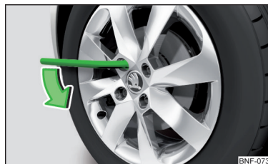
Fig. 153 Slăbirea șuruburilor de roată
