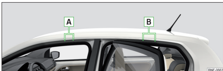
Fig. 87 Puncte de fixare - autovehicul cu 5 uși
