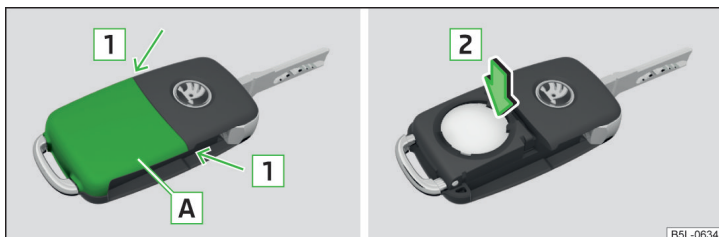
Fig. 160 Îndepărtarea capacului / extragerea bateriei
