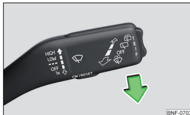
Fig. 163 Reglarea poziției de service a brațelor ștergătoarelor de parbriz
