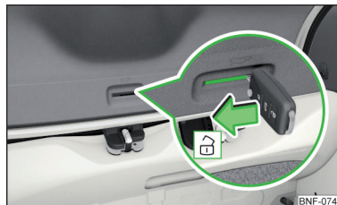
Fig. 162 Descuierea capotei portbagajului
