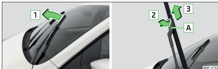
Fig. 164 Înlocuirea lamelei ștergătorului de parbriz
