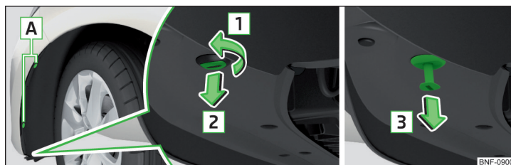
Fig. 178 Demontarea capitonajului pasajului roții
