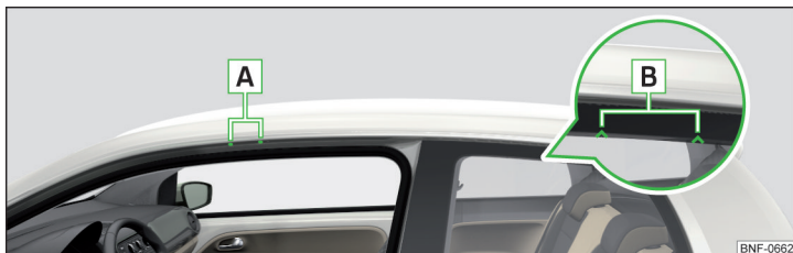
Fig. 86 Puncte de fixare - autovehicul cu 3 uși
