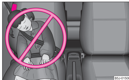
Fig. 125 Copil neasigurat corect într-o poziție incorectă - siguranța periclitată de airbag-ul lateral
