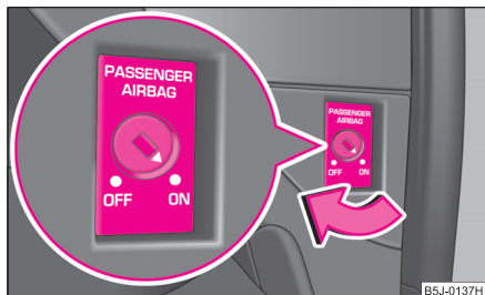
Fig. 122 Comutator pentru airbag-ul pasagerului din dreapta
