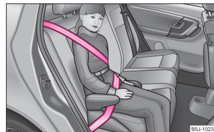
Fig. 130 Scaun pentru copii din grupa 3 montat pe scaunul din spate
