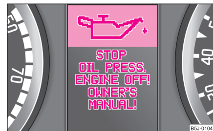
Fig. 13 Display-ul cu informații: presiunea uleiului scăzută
