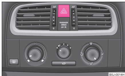
Fig. 37 Tabloul de bord: Înterupător pentru instalația de avertizare avarie
