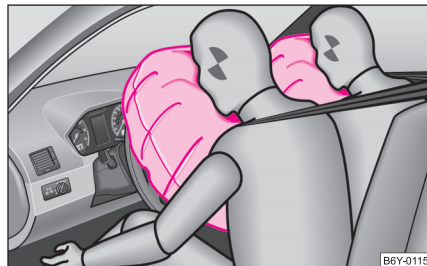
Fig. 116 Airbag umplut cu gaz
