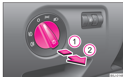
Fig. 35 Tabloul de bord: Întrerupătorul de lumină
