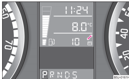
Fig. 4 Indicatorul intervalelor de service: Indicație
