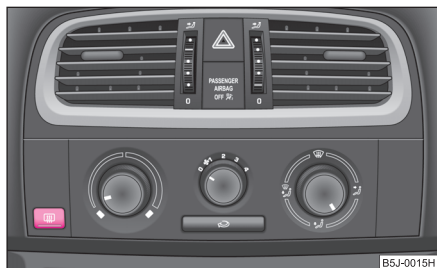
Fig. 42 Întrerupător pentru încălzirea lunetei
