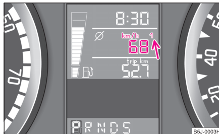
Fig. 5 Tabloul de instrumente: Indicatorul multifuncțional
