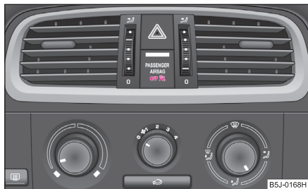
Fig. 123 Lampa de control pentru deconectarea airbag-ului pasagerului din dreapta
