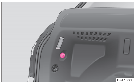
Fig. 181 Demontarea lămpii din spate
