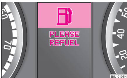
Fig. 14 Display-ul cu informații: Rezerva de combustibil prea scăzută
