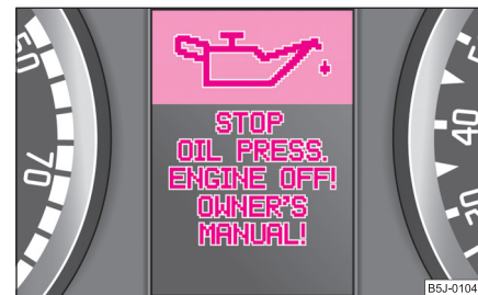
Fig. 13 Display-ul cu informații: presiunea uleiului scăzută
