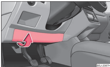
Fig. 204 Tabloul de bord, partea de jos: Capacul suportului de siguranțe
