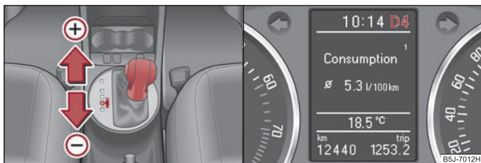
Fig. 101 Selector: selectarea manuală / afișajul mare de informații: selectarea manuală a vitezelor
