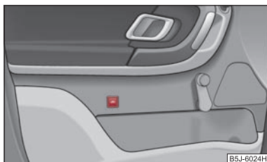
Fig. 32 Tasta instalației de supraveghere interioară
