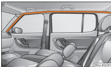
Fig. 119 Amplasarea airbagurilor cortină
