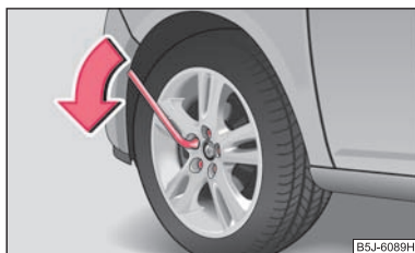
Fig. 154 Înlucuirea roții: Slăbirea șuruburilor de roți
