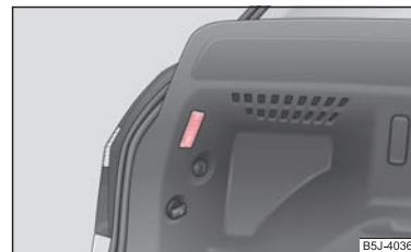
Fig. 177 Demontarea lămpii din portbagaj
