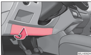
Fig. 161 Tabloul de bord, partea de jos: Capacul suportului de siguranțe
