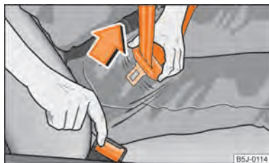
Fig. 101 Eliberarea elementului de prindere din dispozitiv
