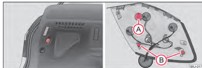
Fig. 165 Demontarea unității de iluminare din spate/Montarea unității de iluminare din spate
