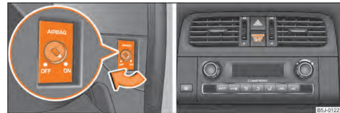
Fig. 109 Comutatorul pentru airbagul frontal al pasagerului față/Lampa de control pentru dezactivarea airbagului pasagerului față
