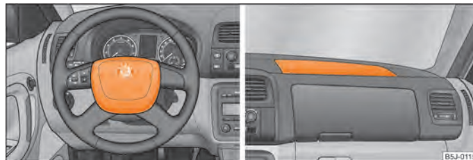
Fig. 102 airbagul șoferului în volan/airbagul pasagerului față în tabloul de bord
