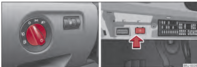
Fig. 22 Tabloul de bord: Comutatorul pentru lumini/Compartimentul siguranțelor: Comutatorul pentru lumina de zi
