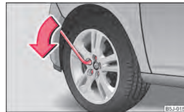
Fig. 142 Înlocuirea roții: Slăbirea șuruburilor de roată
