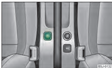
Fig. 119 Tastă pentru reglarea presiunii din pneuri
