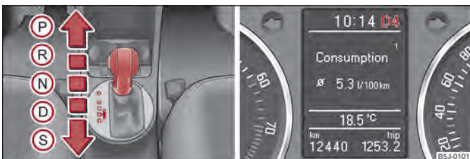
Fig. 88 Selectorul de viteze/Displayul informativ: Pozițiile selectorului
