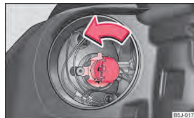
Fig. 160 Demontarea becului luminii de drum
