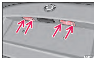
Fig. 164 Demontarea lămpii numărului de înmatriculare
