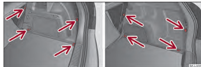
Fig. 44 Portbagajul: Inelele și elementele de prindere (Fabia)/(Combi)
