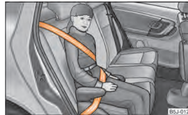
Fig. 115 Scaun pentru copii din grupa 3 montat pe scaunul din spate, cu fața la sensul de mers
