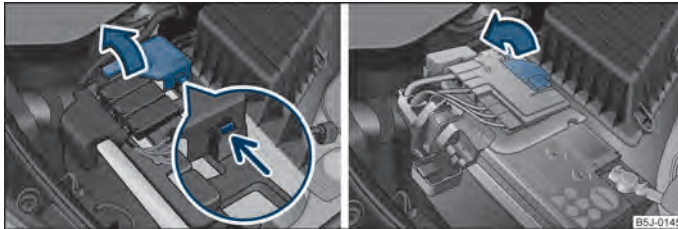
Fig. 132 Bateria: Se ridică capacul (cutie de viteze automată) / (cutie de viteze manuală)
