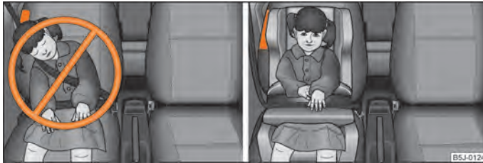
Fig. 111 Copil neasigurat corect/Copil asigurat corect într-un scaun pentru copii
