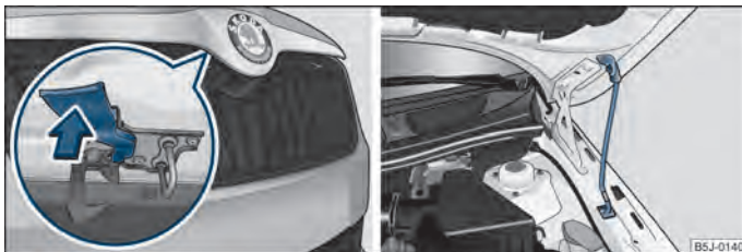
Fig. 127 Grilajul radiatorului: Maneta de siguranță/Asigurarea capotei motorului cu tija de susținere
