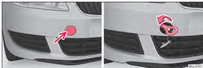
Fig. 149 Bara de protecție față: Capacul/montarea inelului de remorcare
