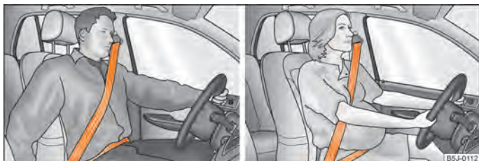
Fig. 99 Așezarea centurii diagonale și transversale/Așezarea centurii de siguranță la femeile însărcinate
