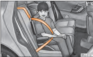
Fig. 114 Scaun pentru copii din grupa 2 montat pe scaunul din spate, cu fața la sensul de mers
