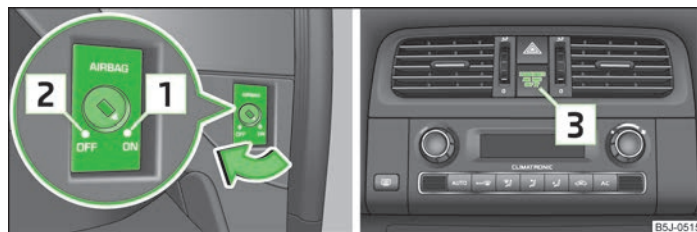
Fig. 106 Comutator cu cheie pentru airbagul frontal al pasagerului față / lampă de control pentru dezactivarea airbagului frontal al pasagerului față
