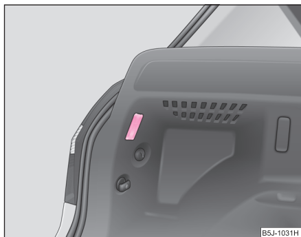
Fig. 181 Demontarea lămpii din portbagaj
