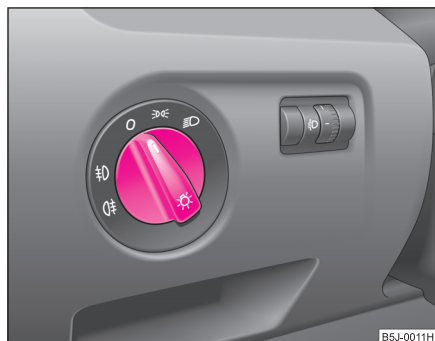
Fig. 34 Tabloul de bord: înterupătorul de lumină
