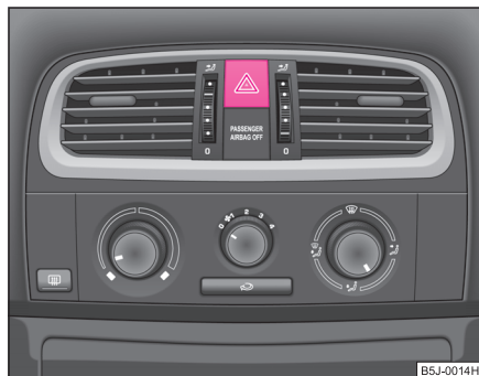
Fig. 38 Tabloul de bord: întrerupător pentru instalația de avertizare avarie
