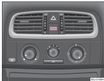
Fig. 122 Lampa de control pentru deconectarea airbag-ului pasagerului din dreapta
