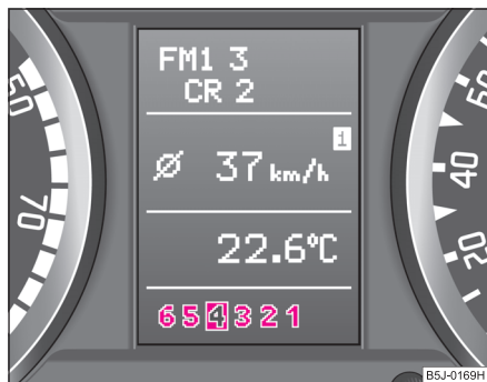
Fig. 97 Display-ul cu informații: selec-tarea manuală a vitezelor
