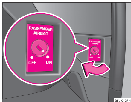
Fig. 121 Comutator pentru airbag-ul pasagerului din dreapta
