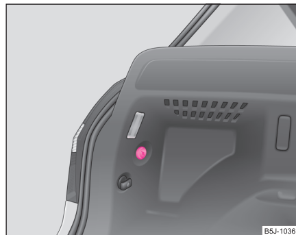
Fig. 178 Demontarea lămpii din spate
