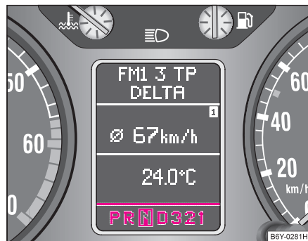
Fig. 97 Display-ul cu informații în tabloul de instrumente: Pozițiile selectorului
