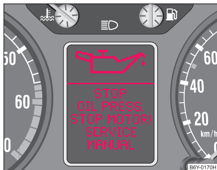
Fig. 14 Display-ul de informații: presiune scăzută a uleiului
