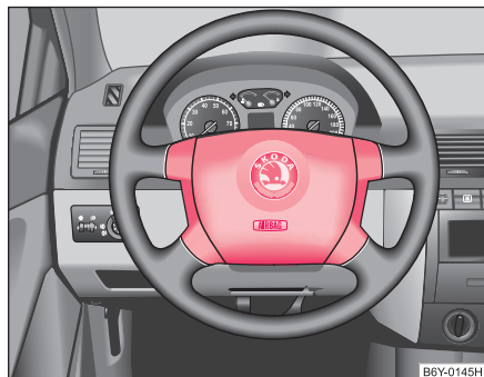
Fig. 99 Airbag-ul conducătorului auto situat în volan
