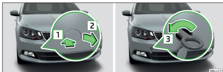
Fig. 169 Demontarea capacului / Montarea cârligului de tractare
