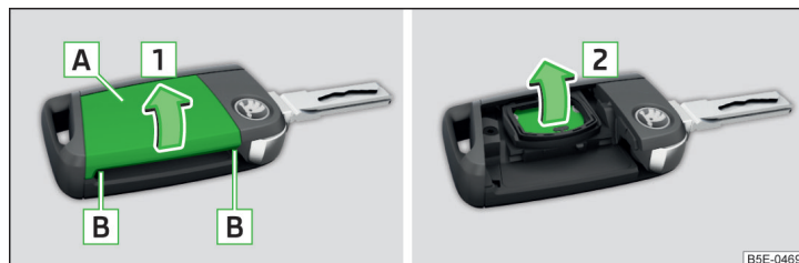
Fig. 171 Demontarea capacului / scoaterea bateriei
