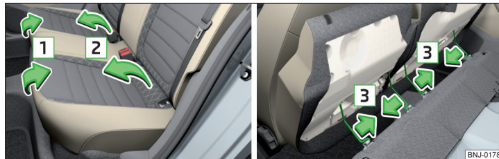
Fig. 60 Rabatarea înspre înainte a banchetei din spate / scoaterea banchetei din spate divizate
