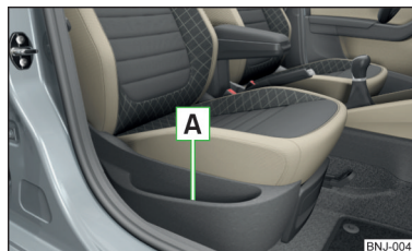
Fig. 64 Compartimentul de depozitare
