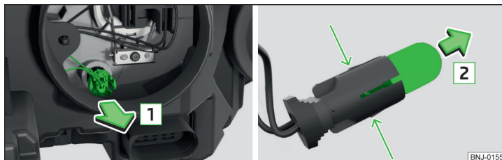
Fig. 187 Înlocuirea becului luminii de poziție
