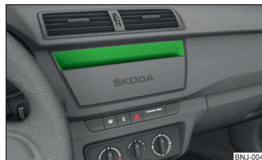
Fig. 67 Compartimentul de depozitare
