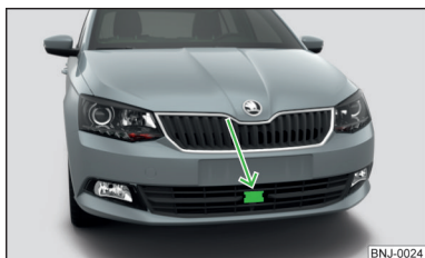
Fig. 123 Locul de amplasare al senzorului radar
