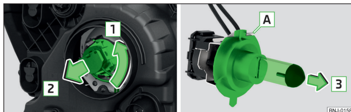
Fig. 190 Înlocuirea becului luminii de drum
