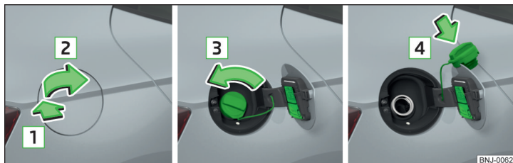
Fig. 143 Deschiderea clapetei rezervorului de combustibil / Deșurubarea bușonului rezervorului de combustibil / Introducerea bușonului rezervorului de combustibil în clapeta rezervorului de combustibil
