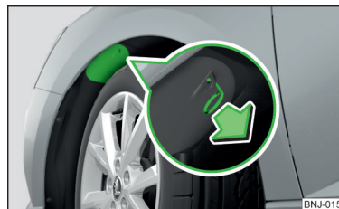
Fig. 183 Demontarea capacului din material plastic
