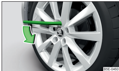
Fig. 183 Înlocuirea roții: Slăbirea șuruburilor de roată
