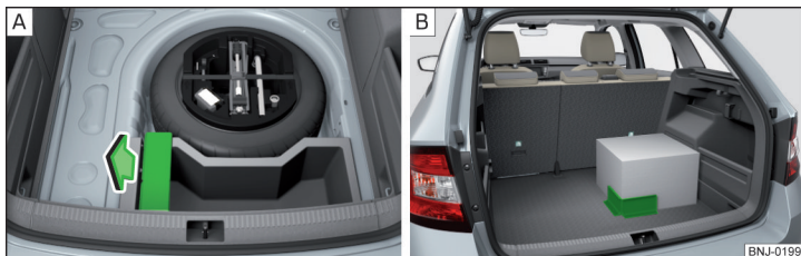
Fig. 104 Scoaterea elementului Cargo/exemplu de fixare a încărcăturii prin intermediul elementului Cargo
