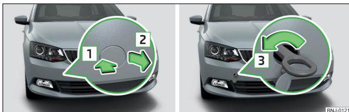
Fig. 190 Demontarea capacului/Montarea cârligului de tractare
