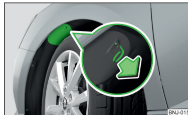
Fig. 204 Demontarea capacului din material plastic
