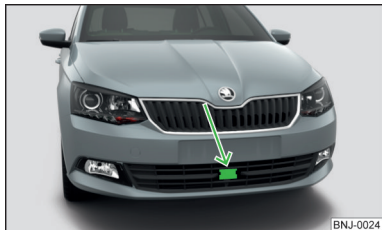
Fig. 144 Locul de amplasare al senzorului radar
