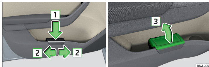
Fig. 78 Recipientul pentru reziduuri: introducerea sau deplasarea/deschiderea
