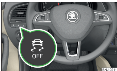
Fig. 132 Tasta de sistem: Dezactivarea/activarea ASR
