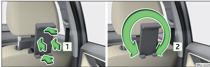
Fig. 92 Înclinarea și rotirea suportului
