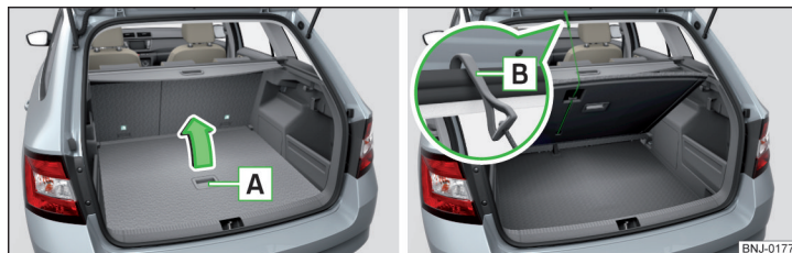
Fig. 109 Rabaterea în sus a podelei variabile/fixarea podelei variabile
