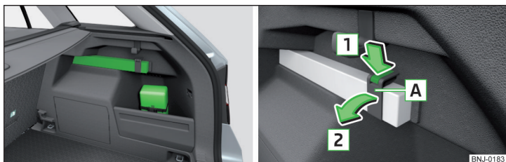
Fig. 176 Amplasarea trusei de prim-ajutor și a triunghiului reflectorizant, varianta 2/desfacerea curelei de fixare
