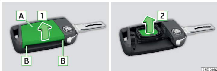
Fig. 192 Cheia cu telecomandă: Demontarea capacului/scoaterea bateriei
