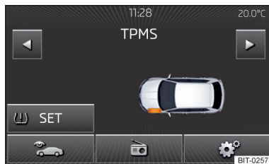
Fig. 148 Tasta pentru memorarea valorilor presiunii/exemplu de indicator de pe afișaj: sistemul atrage atenția asupra unei modificări a presiunii anvelopei din stânga față
