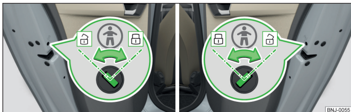
Fig. 41 Portiera spate: Activarea/dezactivarea siguranței pentru copii
