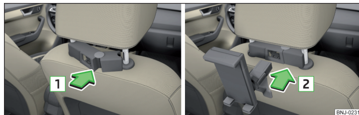
Fig. 90 Montarea adaptorului/montarea suportului
