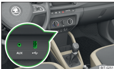
Fig. 89 Locurile de montare ale intrărilor AUX și USB
