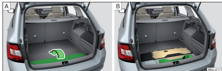
Fig. 103 Plierea podelei/compartimentul de depozitare de sub podea
