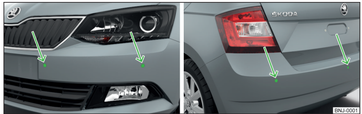
Fig. 133 Locul de amplasare al senzorilor pe partea stângă a autovehiculului: față/spate
