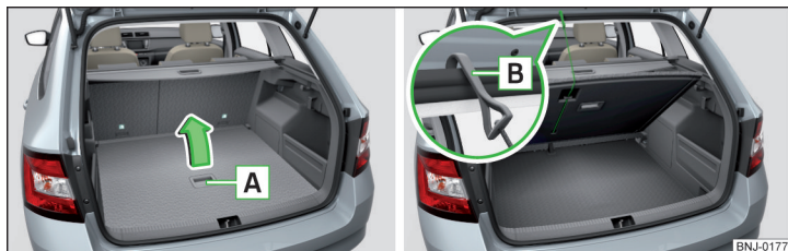
Fig. 104 Rabatarea în sus a podelei variabile/fixarea podelei variabile
