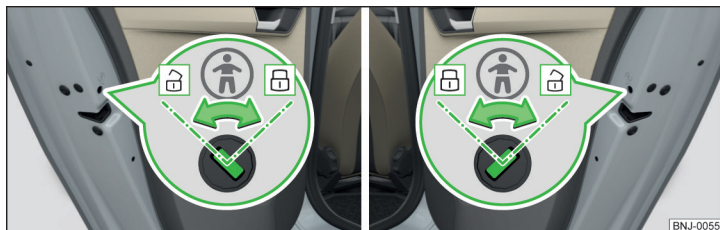
Fig. 35 Portiera spate: Activarea/dezactivarea siguranței pentru copii
