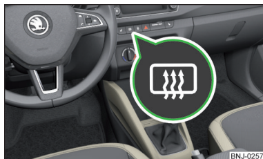
Fig. 47 Tasta pentru încălzire lunetă
