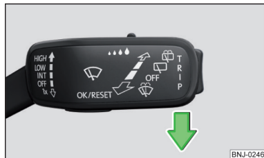
Fig. 197 Reglarea poziției de service a brațelor ștergătoarelor de parbriz
