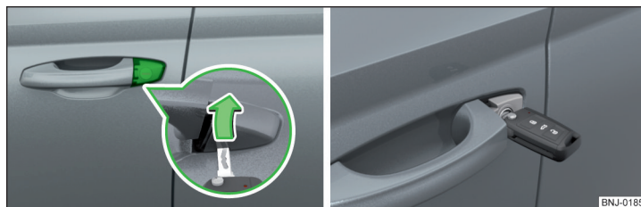
Fig. 193 Mănerul portierei șoferului: Rabatarea capacului încuietorii / butucul încuietorii cu cheie
