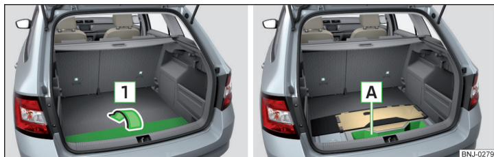
Fig. 99 Plierea podelei/compartimentul de depozitare de sub podea
