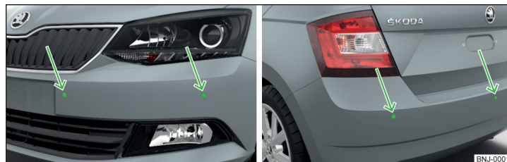
Fig. 219 Locul de amplasare al senzorilor de pe partea stângă a autovehiculului: față/spate
