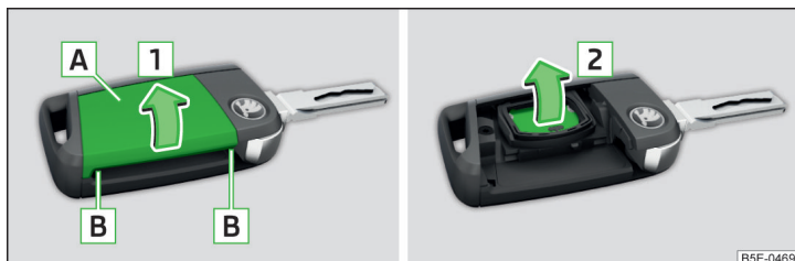
Fig. 282 Ridicarea capacului / scoaterea bateriei
