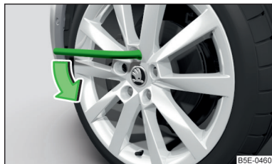
Fig. 274 Slăbirea șuruburilor de roată
