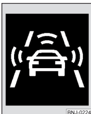
Fig. 238 Afijșajul panoului de bord: Preavertizare, resp. frânare de urgență la o viteză redusă
