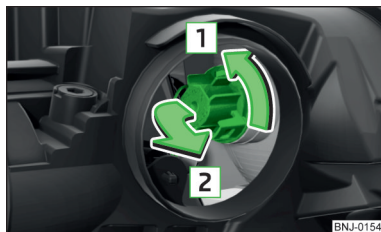
Fig. 301 Înlocuirea becului luminii de semnalizare față
