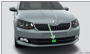
Fig. 217 Locul de montare al senzorului radar
