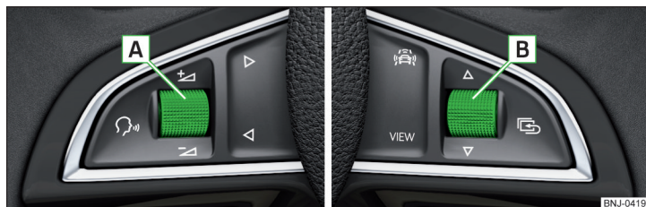
Fig. 39 Butoane/rozete de reglare pe volanul multifuncțional
