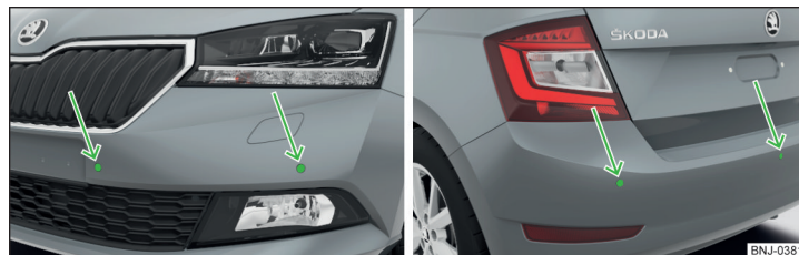
Fig. 205 Locul de amplasare al senzorilor de pe partea stângă a autovehiculului: față/spate
