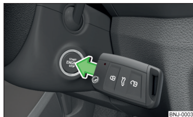
Fig. 193 Porniți motorul - apăsați butonul cu cheie.
