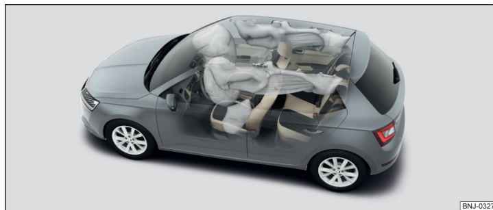
Fig. 21 Airbag umflat cu gaz
