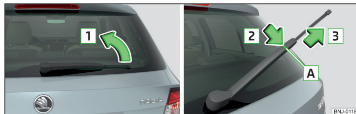
Fig. 279 Înlocuirea lamelei ștergătorului de lunetă
