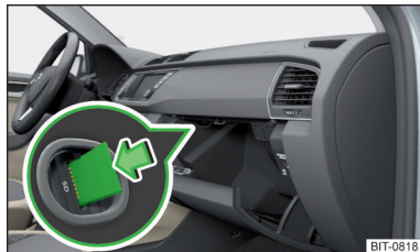
Fig. 147 Amundsen: Introducerea cardului SD
