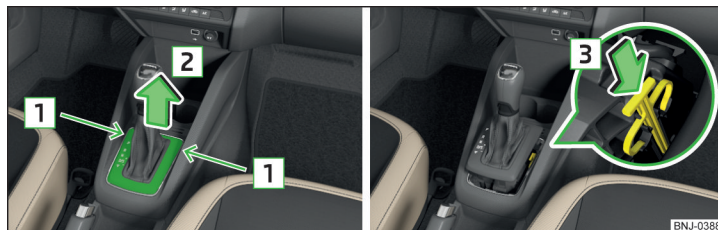
Fig. 276 Scoaterea capacului/deblocarea selectorului de viteze
