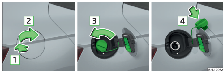
Fig. 245 Deschiderea clapetei rezervorului de combustibil/Deșurubarea bușonului rezervorului de combustibil/Introducerea bușonului rezervorului de combustibil în clapeta rezervorului de combustibil
