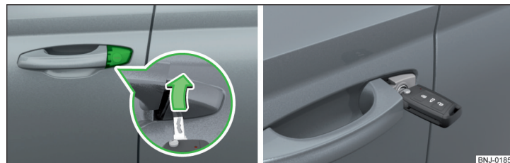
Fig. 273 Mânerul portierei: Rabatarea capacului încuietorii/butucul încuietorii cu cheie
