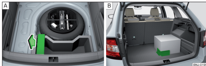
Fig. 113 Scoaterea elementului Cargo/Exemplu de fixare a încărcăturii
