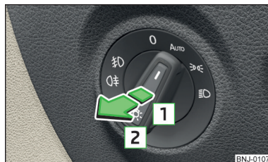
Fig. 58 Comutatorul de lumini - activați farurile de ceață/lampa de ceață spate
