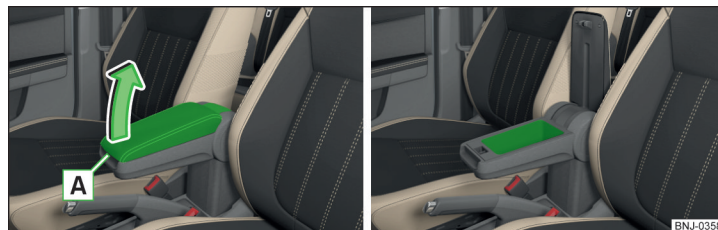
Fig. 87 Deschiderea compartimentului de depozitare/compartiment de depozitare
