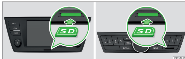
Fig. 148 Swing/Blues: Introducerea cardului SD
