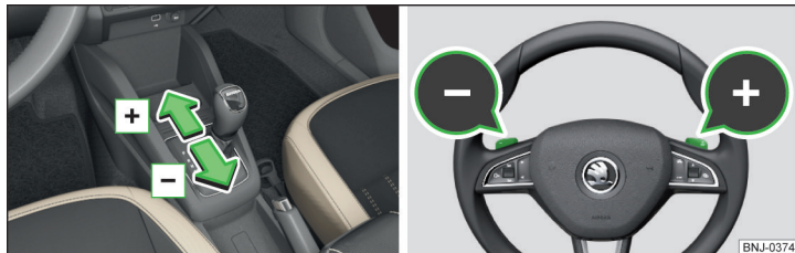
Fig. 200 Maneta selectorului de viteze/volanul multifuncțional
