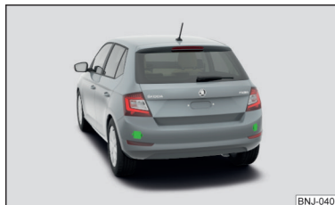
Fig. 210 Locul de amplasare al senzorilor radar
