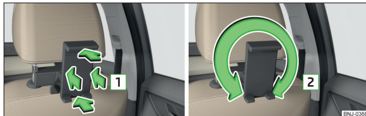
Fig. 101 Înclinarea și rotirea suportului
