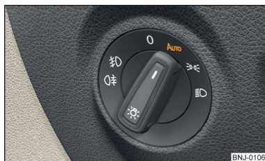
Fig. 56 Comutatorul de lumini: Poziția AUTO
