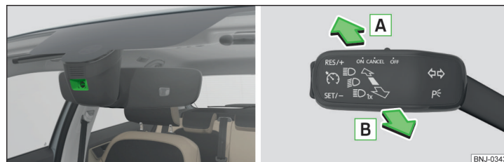
Fig. 57 Amplasarea senzorului/Activarea/dezactivarea sistemului
