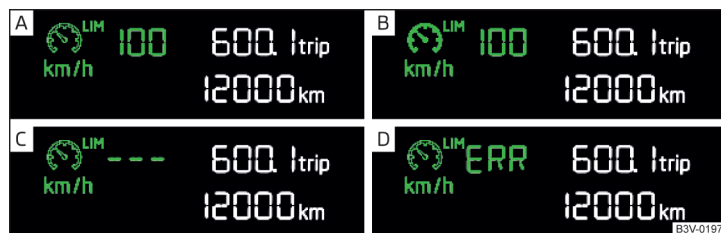
Fig. 220 Afiașajul segment: Exemple de afișări de stare ale limitatorului de viteză
