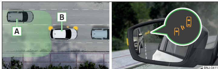
Fig. 212 Situație din trafic/Lampa de control din oglinda exterioară stângă indică asupra situației din trafic
