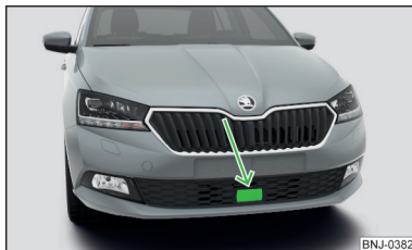
Fig. 203 Locul de montare al senzorului radar
