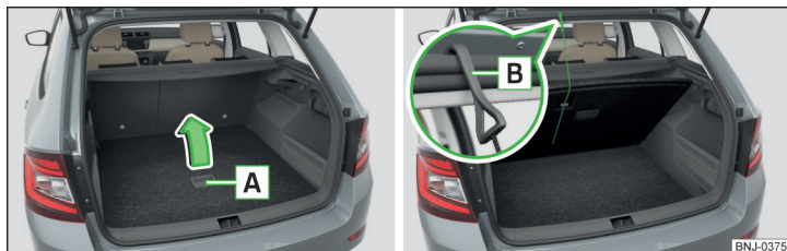
Fig. 120 Rabatarea în sus a podelei variabile/fixarea podelei variabile
