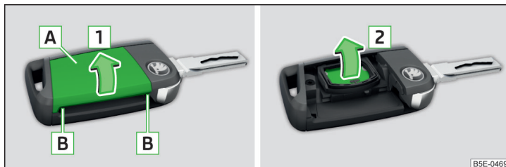
Fig. 271 Ridicarea capacului/scoaterea bateriei
