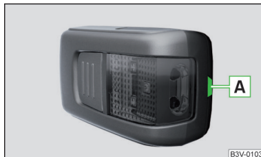
Fig. 272 Clema de blocare de pe capacul acumulatorului
