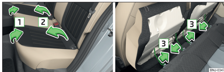
Fig. 72 Rabaterea înspre înainte a banchetei din spate/scoaterea banchetei din spate divizate
