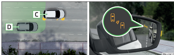
Fig. 213 Situație din trafic/Lampa de control din oglinda exterioară dreapta indică asupra situației din trafic
