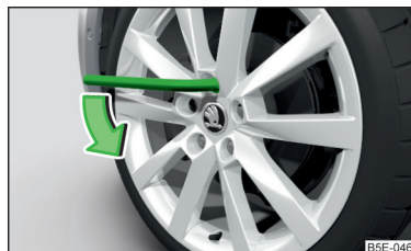
Fig. 313 Slăbirea șuruburilor de roată
