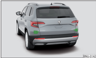
Fig. 257 Locul de amplasare al senzorilor radar
