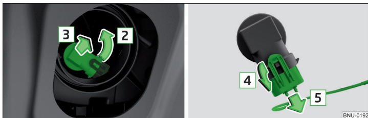
Fig. 342 Înlocuirea becului farului de ceață
