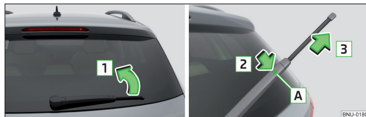
Fig. 330 Înlocuirea lamelei ștergătorului de lunetă
