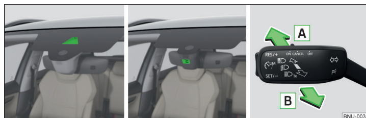
Fig. 60 Variante de amplasare a senzorului/activarea/dezactivarea sistemului
