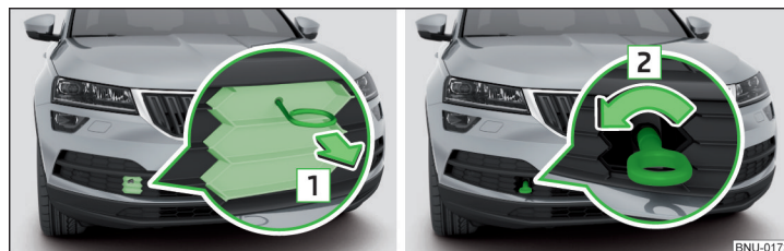
Fig. 319 Scoaterea grilajului de protecție/montarea cârligului de tractare
