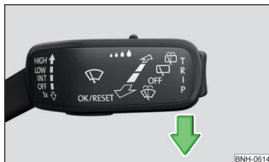
Fig. 328 Reglarea poziției de service a brațelor ștergătoarelor de parbriz
