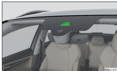
Fig. 294 Senzor pentru recunoașterea indicatoarelor rutiere
