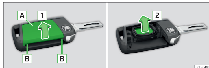
Fig. 330 Ridicarea capacului / scoaterea bateriei
