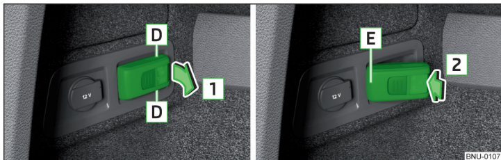
Fig. 154 Demontarea lămpii/montarea lămpii
