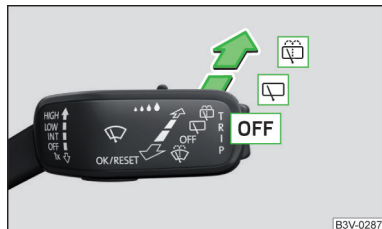
Fig. 76 Operarea instalației de ștergere și spălare a geamurilor
