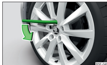
Fig. 322 Slăbirea șuruburilor de roată
