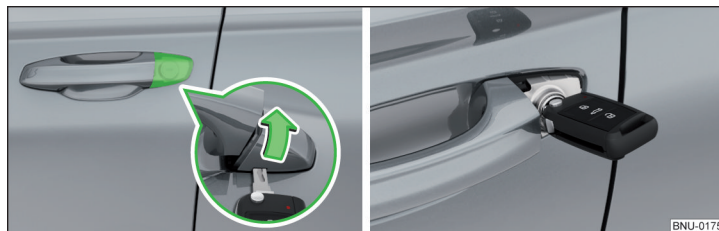
Fig. 333 Mănerul portierei șoferului: Rabatarea capacului încuietorii / butucul încuietorii cu cheia
