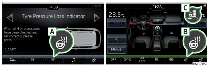
Fig. 100 Încălzirea volanului: Instalație de climatizare manuală/Climatronic
