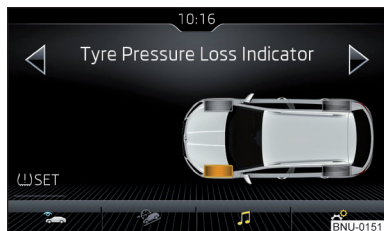
Fig. 296 Tasta de memorare/exemplu pentru afișajul de pe ecran: se atrage atenția asupra unei modificări a presiunii anvelopei din stânga față
