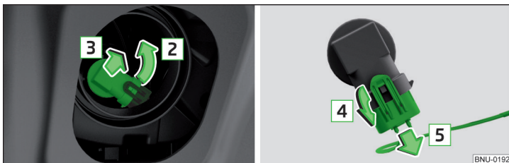
Fig. 351 Înlocuirea becului farului de ceață
