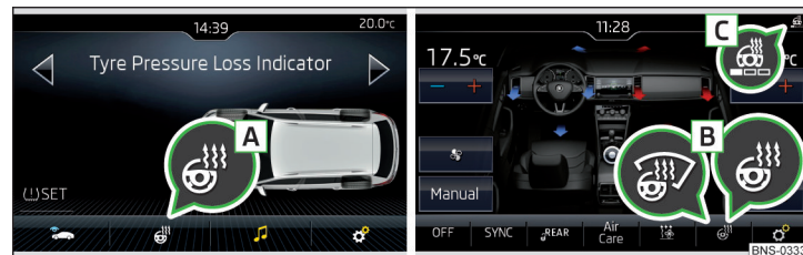
Fig. 105 Încălzirea volanului: Instalație de climatizare manuală / Climatronic
