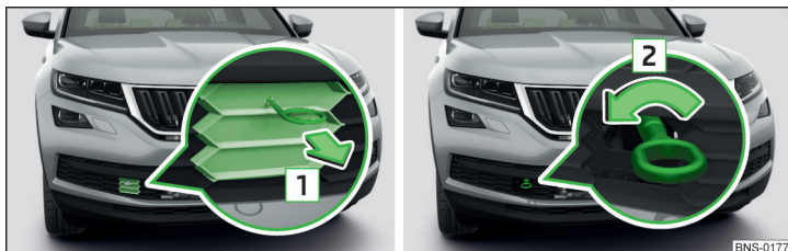
Fig. 346 Scoaterea grilajului de protecție/montarea cârligului de tractare
