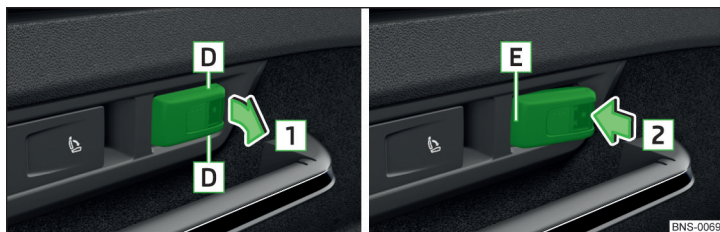
Fig. 153 Demontarea lămpii / montarea lămpii
