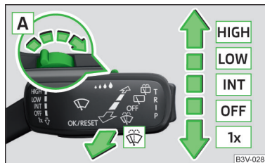
Fig. 79 Operarea instalației de ștergere și spălare a parbrizului
