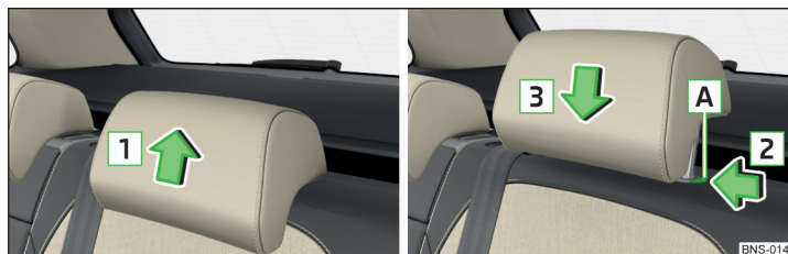
Fig. 97 Reglarea înălțimii tetierelor de pe rândul al doilea de scaune
