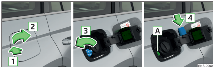
Fig. 322 Deschiderea clapetei rezervorului de combustibil/Deșurubarea bușonului rezervorului de combustibil/Introducerea bușonului rezervorului de combustibil în clapeta rezervorului de combustibil
