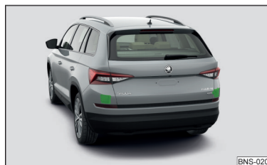
Fig. 271 Locul de amplasare al senzorilor radar
