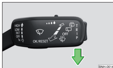
Fig. 358 Reglarea poziției de service a brațelor ștergătoarele de parbriz
