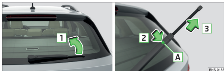
Fig. 360 Înlocuirea lamei ștergătorului de lunetă
