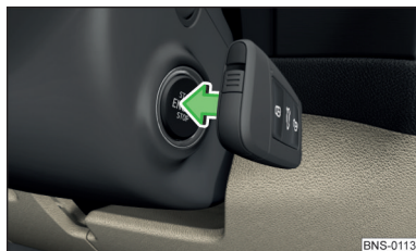
Fig. 250 Pornirea motorului - Mențineți cheia lângă buton
