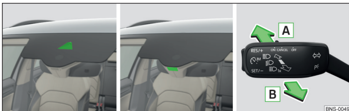
Fig. 69 Variante de amplasare a senzorului/activarea/dezactivarea sistemului
