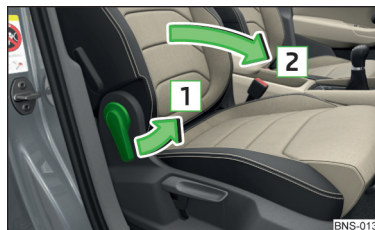
Fig. 86 Rabatarea înspre înainte a scaunului pasagerului față
