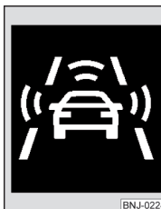
Fig. 306 Afișajul panoului de bord: Preavertizare, resp. frânare de urgență la o viteză redusă
