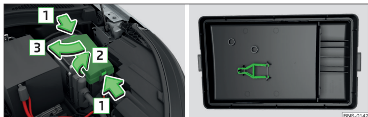
Fig. 365 Capacul panoului de siguranțe: detașarea capacului / clemă de material plastic pentru siguranțe
