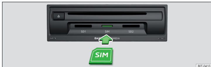
Fig. 202 Introducerea cartelei SIM în modulul extern
