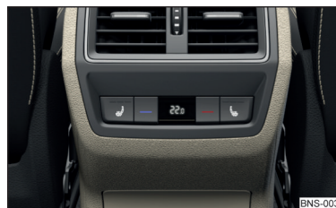
Fig. 33 Afișajul din consola centrală spate
