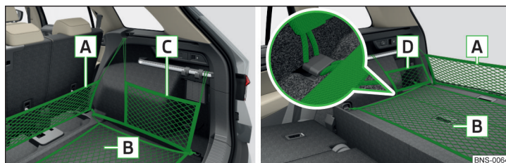
Fig. 142 Exemple de fixare a plaselor: Varianta cu 5 locuri/varianta cu 5 locuri și cu podea de încărcare variabilă
