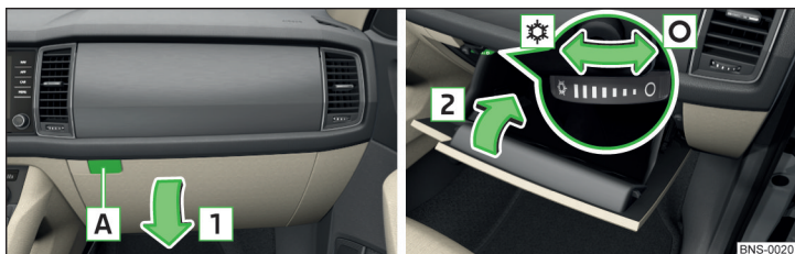
Fig. 120 Deschiderea/închiderea compartimentului de depozitare inferior și operarea admisiei aerului
