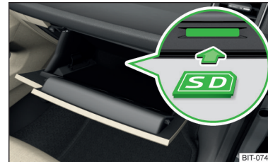
Fig. 193 Columbus, Amundsen, Bolero: Introducerea cardului SD
