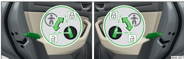
Fig. 56 Portiera spate: Activarea/dezactivarea siguranței pentru copii
