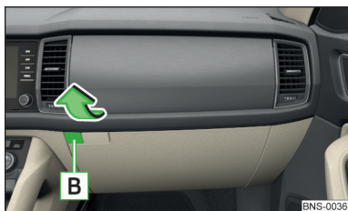
Fig. 121 Deschiderea compartimentului de depozitare superior
