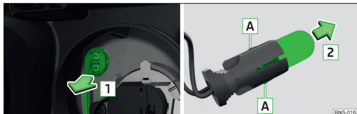
Fig. 369 Înlocuirea becului luminii de poziție
