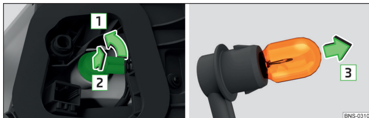
Fig. 376 Înlocuirea becului/montarea lămpii
