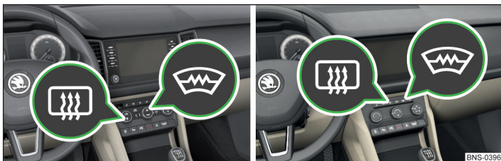
Fig. 76 Taste pentru încălzirea parbrizului și lunetei: Climatronic/Sistemul manual de aer condiționat
