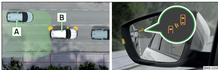
Fig. 273 Situație din trafic/Lampa de control din oglinda exterioră stângă indică asupra situației din trafic
