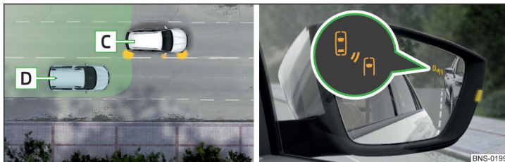
Fig. 274 Situație din trafic/Lampa de control din oglinda exterioră dreapta indică asupra situației din trafic
