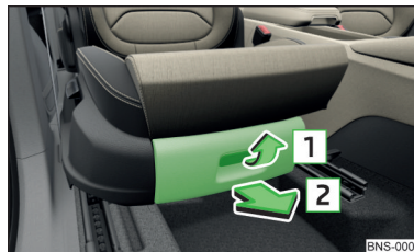
Fig. 122 Deschiderea compartimentului de depozitare
