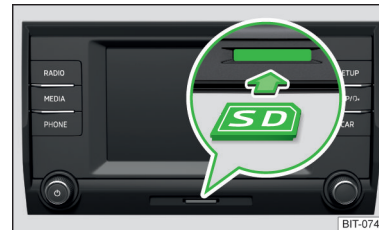
Fig. 194 Swing: Introducerea cardului SD
