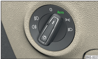
Fig. 68 Comutatorul de lumini: Poziția AUTO
