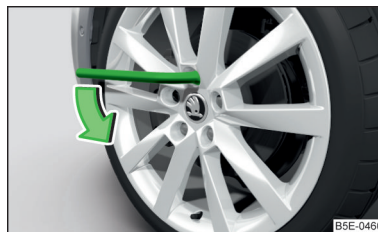
Fig. 340 Slăbirea șuruburilor de roată
