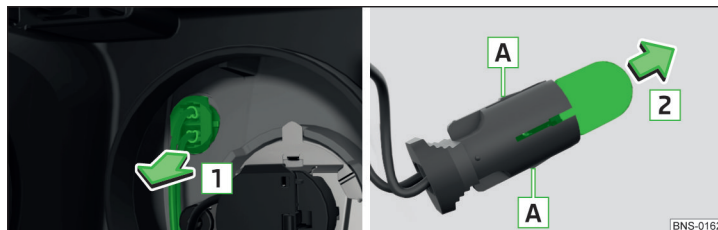
Fig. 372 Înlocuirea becului luminii de poziție
