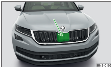
Fig. 263 Locul de montare al senzorului radar
