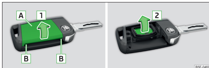
Fig. 351 Ridicarea capacului / scoaterea bateriei
