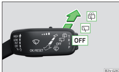
Fig. 82 Operarea instalației de ștergere și spălare a geamurilor
