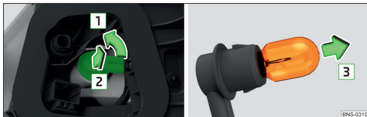
Fig. 379 Înlocuirea becului/montarea lămpii
