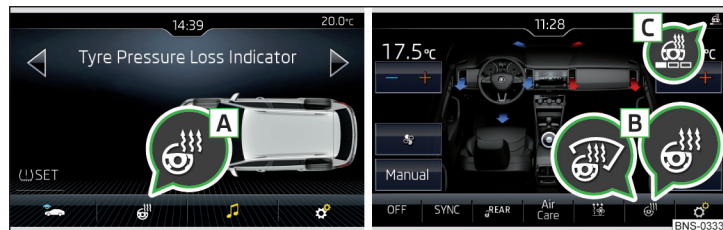
Fig. 107 Încălzirea volanului: Instalație de climatizare manuală / Climatronic
