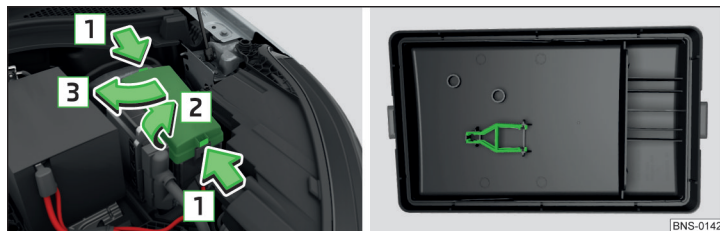
Fig. 368 Capacul panoului de siguranțe: detașarea capacului / clemă de material plastic pentru siguranțe
