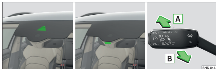
Fig. 71 Variante de amplasare a senzorului/activarea/dezactivarea sistemului
