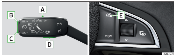
Fig. 299 Elementele de comandă ale limitatorului de viteză: Manetă / volan multifuncțional
