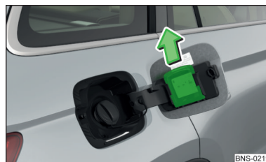
Fig. 319 Locul de montare al racletei, scoaterea racletei
