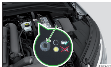
Fig. 330 Bateria autovehiculului: Indica- torul nivelului electrolitului
