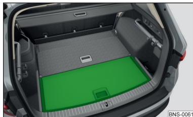
Fig. 160 Podea de încărcare variabilă în- toarsă pe cealaltă față
