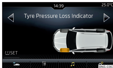
Fig. 314 Tasta pentru memorare / exemplu de afișare pe ecran: se atrage atenția asupra modificării presiunii din anvelopa din stânga față
