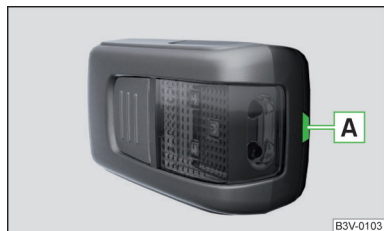
Fig. 355 Clema de blocare de pe capacul acumulatorului
