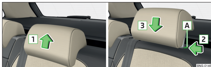
Fig. 99 Reglarea înălțimii tetierelor de pe rândul al doilea de scaune
