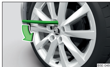
Fig. 342 Slăbirea șuruburilor de roată
