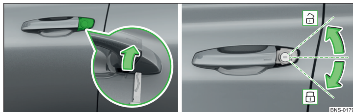
Fig. 356 Mănerul portierei șoferului: Deschiderea capacului încuietorii/descuierea și închuirea
