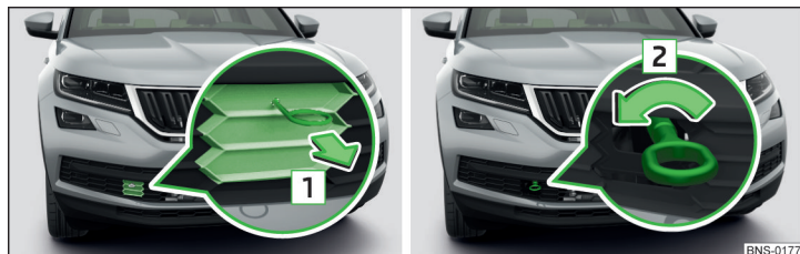
Fig. 349 Scoaterea grilajului de protecție/montarea cârligului de tractare
