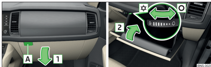
Fig. 122 Deschiderea/închiderea compartimentului de depozitare inferior și operarea admisiei aerului
