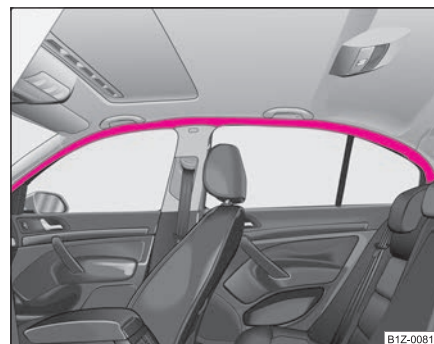
Fig. 167 Amplasarea airbag-urilor pentru cap
