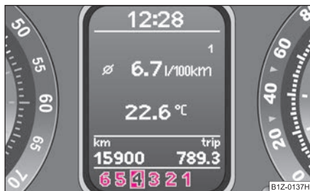
Fig. 147 Display-ul cu informații: selecția manuală a vitezelor
