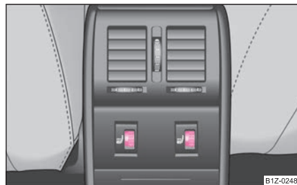
Fig. 71 Consola centrală spate: Regulator rotativ pentru încălzirea scaunelor din spate
