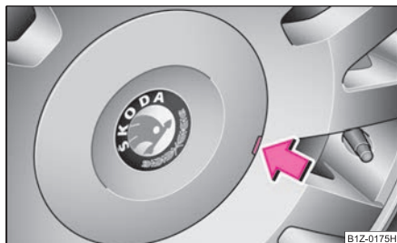
Fig. 213 Scoaterea ornamentului de roată la jantele din metal ușor
