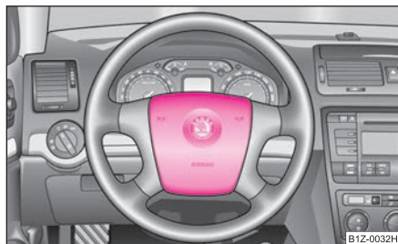
Fig. 164 Airbag-ul din volan pentru conducător
