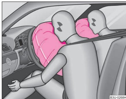
Fig. 166 Airbag umplut cu gaz
