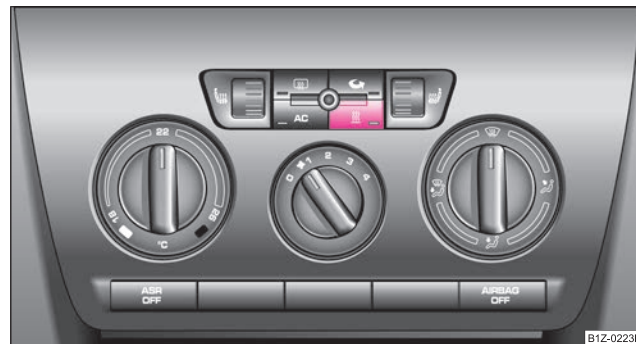
Fig. 129 Tasta pentru pornirea/oprirea directă a încălzirii suplimentare (încălzirea și ventilația în staționare) de la elementele de comandă Climatic
