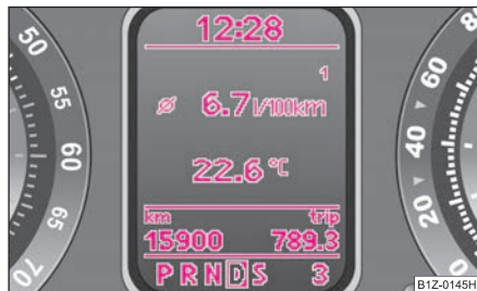
Fig. 10 Tabloul de instrumente: Display-ul cu informații
