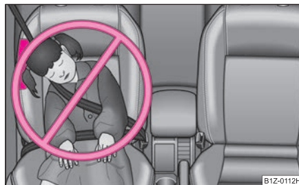
Fig. 175 Copil neasigurat corect într-o poziție incorectă - siguranța periclitată de airbag-ul lateral
