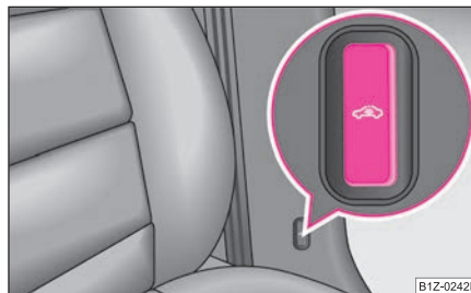
Fig. 33 Tasta instalației de supraveghere interioară
