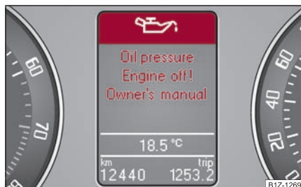
Fig. 32 Display-ul cu informații: presiunea uleiului scăzută
