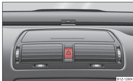
Fig. 59 Tabloul de bord: Înterupător pentru instalația de avertizare avarie
