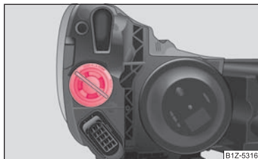
Fig. 194 Demontarea becului cu incandescență al luminii de semnalizare din față
