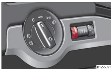
Fig. 40 Tabloul de bord: Iluminarea instrumentelor de bord
