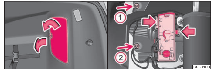
Fig. 201 Spațiul pentru bagaje: Capacul suportului becului/Demontarea suportului lămpii
