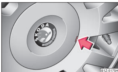
Fig. 178 Scoaterea ornamentului de roată la jantele din metal ușor
