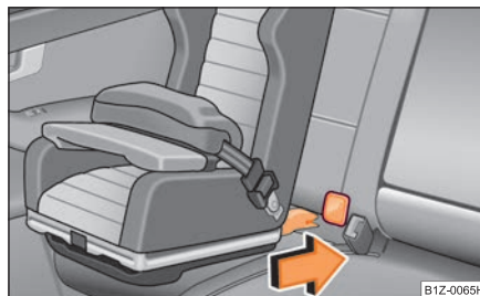
Fig. 195 Scaunul cu sistem ISOFIX se montează în dispozitivele de prindere existente.
