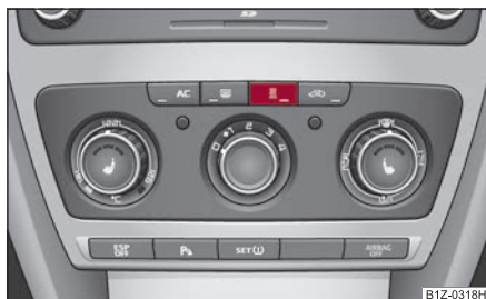
Fig. 143 Tasta pentru pornirea/oprirea directă a încălzirii suplimentare (încălzirea și ventilația în staționare) de la elementele de comandă Climatic
