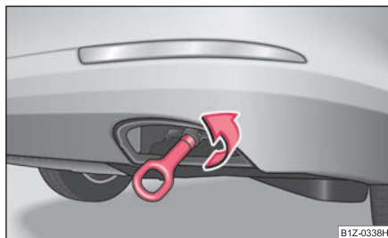
Fig. 234 Bara de protecție din spate: Montarea inelului de remorcare
