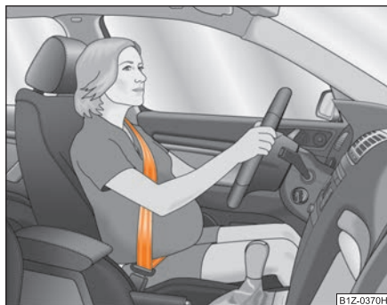
Fig. 174 Dispunerea benzii centurii la femeile însărcinate
