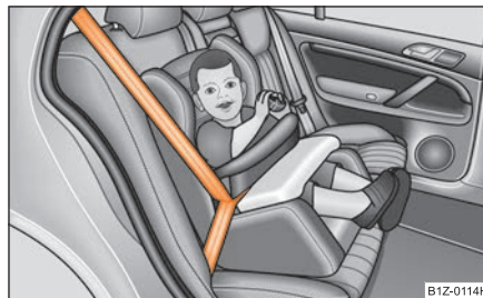
Fig. 191 Scaun cu măsuta de siguranță din grupa 1 montat pe bancheta din spate, cu fața la sensul de mers.
