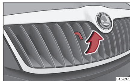
Fig. 15 Grilajul radiatorului: Mâner
