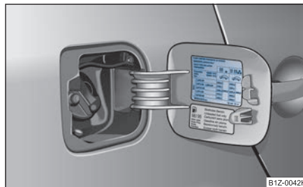
Fig. 218 Clapeta rezervorului deschisă și tabelul cu datele referitoare la presiune
