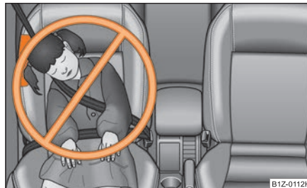
Fig. 188 Copil neasigurat corect într-o poziție incorectă – siguranța periclitată de airbag-ul lateral
