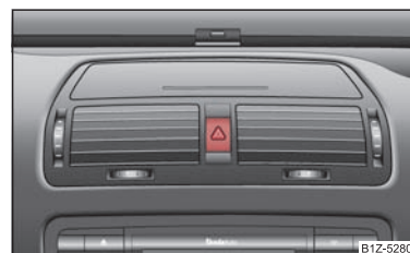
Fig. 42 Tabloul de bord: Înterupător pentru instalația de avertizare avarie
