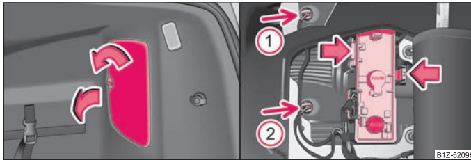
Fig. 197 Portbagajul: Capacul suportului becului / Demontarea suportului lămpii
