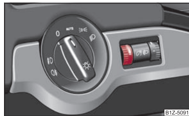
Fig. 40 Tabloul de bord: Iluminarea instrumentelor de bord
