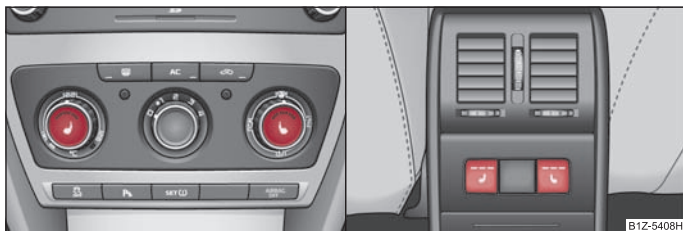
Fig. 64 Tabloul de bord: Regulator pentru încălzirea scaunelor din față / spate
