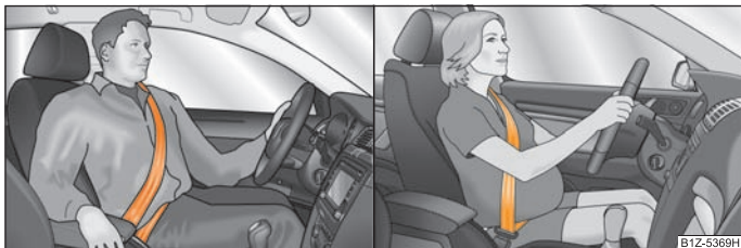
Fig. 130 Centura de siguranță pentru umăr și bazin
