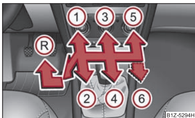
Fig. 112 Schemă de selectare: Cutie de viteze cu 5 trepte sau cu 6 trepte
