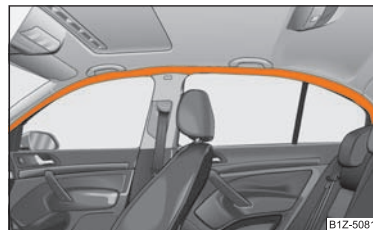
Fig. 138 Amplasarea airbagurilor cortină
