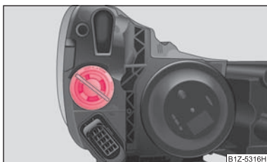
Fig. 191 Demontarea becului cu incandescentă al luminii de semnalizare din față
