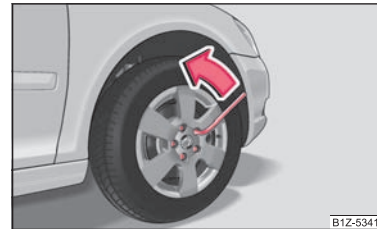
Fig. 178 Înlocuirea roții: Slăbirea șuruburilor de roți
