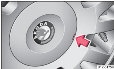
Fig. 177 Scoaterea ornamentului de roată la jantele din metal ușor
