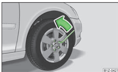
Fig. 148 Înlucuirea roții: Slăbirea șuruburilor de roată
