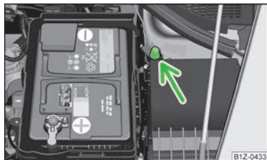
Fig. 154 Pornirea asistată - sistemul START-STOP
