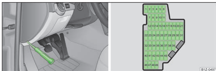
Fig. 158 Capacul cutiei cu siguranțe din panoul de bord / Reprezentare schematică a cutiei cu siguranțe
