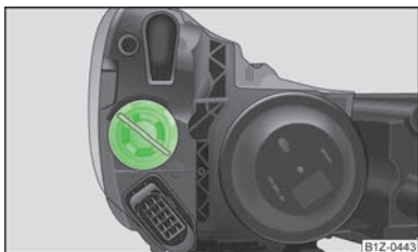
Fig. 161 Înlocuirea becului luminii de semnalizare față
