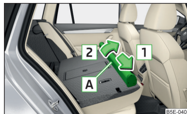
Fig. 131 Demontarea carcasei peretelui despărțitor din plasă
