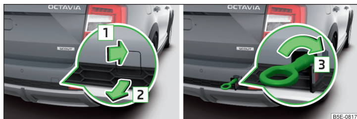
Fig. 331 Scoaterea capacului / montarea cârligului de tractare - varianta 2
