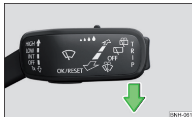
Fig. 339 Reglarea poziției de service a brațelor ștergătoarelor de parbriz
