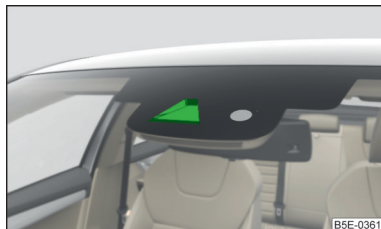
Fig. 284 Senzor pentru recunoașterea indicatoarelor rutiere
