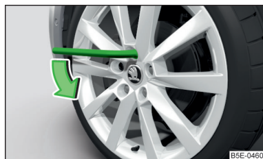
Fig. 323 Slăbirea șuruburilor de roată
