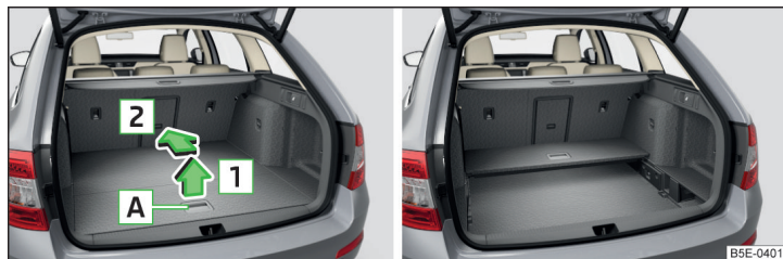
Fig. 127 Rabatarea podelei variabile / podea variabilă rabatată, în poziție superioară
