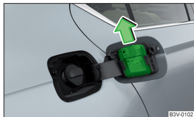
Fig. 301 Locul de montare al racletei, scoaterea racletei
