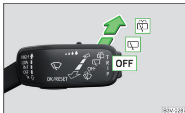
Fig. 61 Operarea instalației de ștergere și spălare a geamurilor
