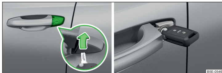
Fig. 335 Mânerul portierei șoferului: Rabatarea capacului încuietorii / butucul încuietorii cu cheie
