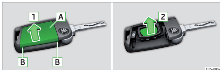
Fig. 332 Ridicarea capacului / scoaterea bateriei
