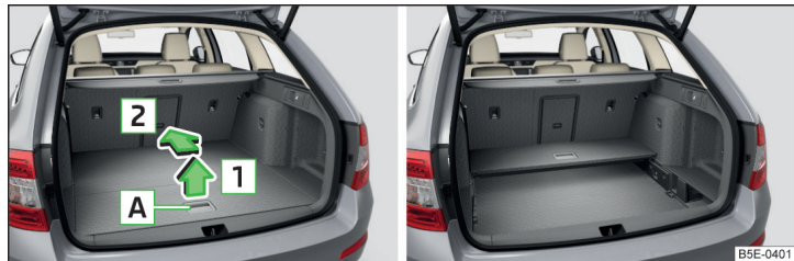
Fig. 120 Rabatarea podelei variabile / podea variabilă rabatată, în poziție superioară
