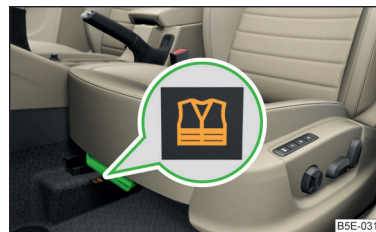
Fig. 207 Compartimentul de depozitare pentru vesta reflectorizantă
