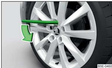
Fig. 213 Înlocuirea roții: Slăbirea șuruburilor de roată
