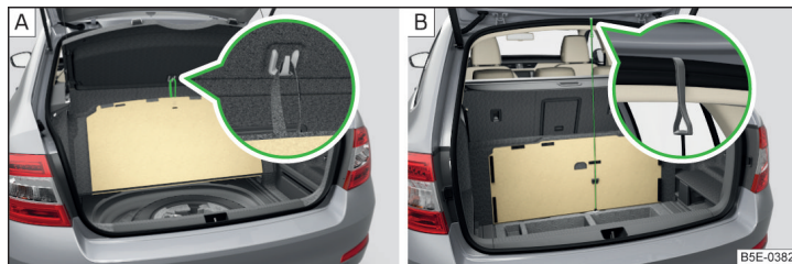
Fig. 108 Fixarea mochetei: Varianta 1/varianta 2
