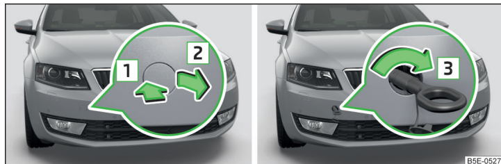
Fig. 220 Demontarea capacului / Montarea cârligului de tractare
