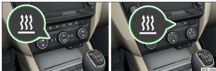
Fig. 132 Tasta pentru pornirea/oprirea directă a încălzirii suplimentare (încălzirea și ventilația în staționare) de la unitatea de comandă Climatronic/sistemul de aer condiționat manual
