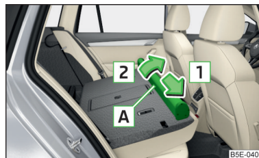
Fig. 124 Demontarea carcasei peretelui despărțitor din plasă
