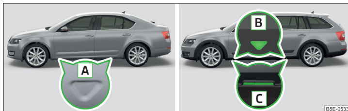
Fig. 214 Puncte pentru fixarea cricului: Varianta 1/varianta 2
