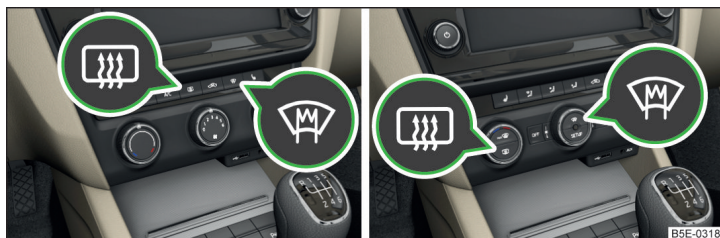
Fig. 63 Taste pentru încălzirea parbrizului și a lunetei: instalație de climatizare manuală, încălzire / Climatronic
