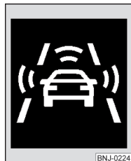
Fig. 168 Simbolul pe afișajul panoului de bord: Preavertizare, resp. frânare de urgență la o viteză redusă
