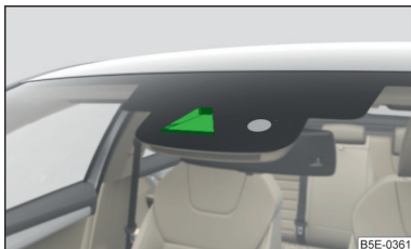
Fig. 174 Domeniul de vizibilitate al camerei pentru recunoașterea indicatoarelor din trafic
