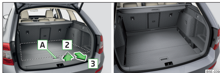
Fig. 119 Reglarea podelei variabile în poziția inferioară / podea variabilă în poziție inferioară
