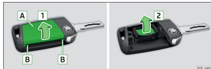
Fig. 223 Demontarea capacului / scoaterea bateriei
