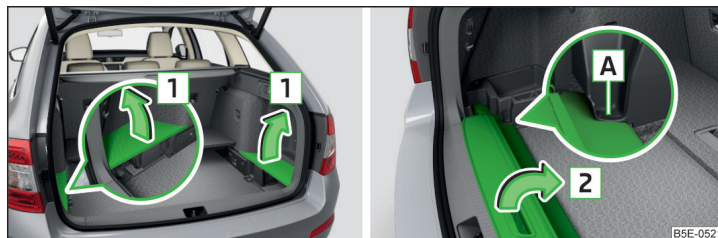
Fig. 113 Scoaterea capacelor laterale ale portbagajului / depozitarea capacului rulabil al portbagajului
