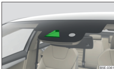
Fig. 55 Vizorul camerei video pentru asistentul pentru faza lungă
