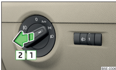
Fig. 57 Comutatorul de lumini: cuplarea farurilor de ceață și a lămpii de ceață spate
