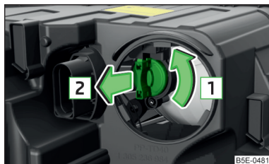
Fig. 238 Becul cu incandescență pentru faza lungă, faza scurtă și lumina de poziție
