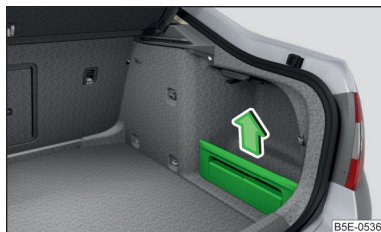
Fig. 114 Scoaterea compartimentului de depozitare
