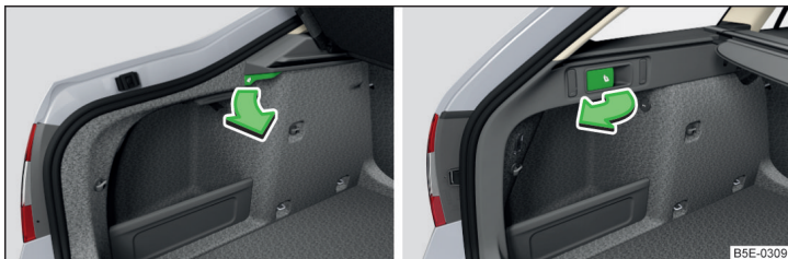
Fig. 80 Rabatarea înainte a spătarului banchetei: Varianta 1/varianta 2
