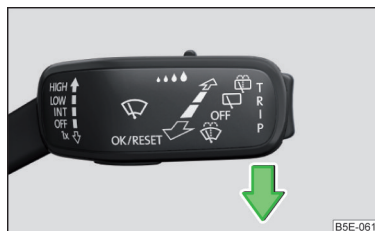
Fig. 225 Reglarea poziției de service a brațelor ștergătoarelor de parbriz
