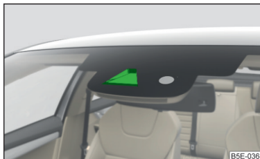
Fig. 170 Senzor pentru recunoașterea indicatoarelor rutiere
