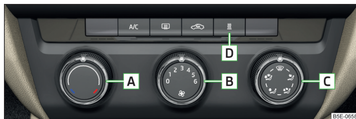
Fig. 126 Elemente de comandă a încălzirii/instalației de climatizare
