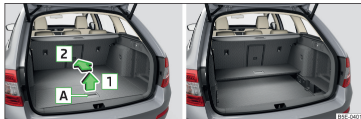
Fig. 119 Rabatarea podelei variabile / podea variabilă rabatată, în poziție superioară
