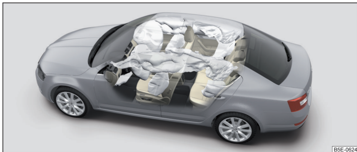
Fig. 8 Airbag umplut cu gaz
