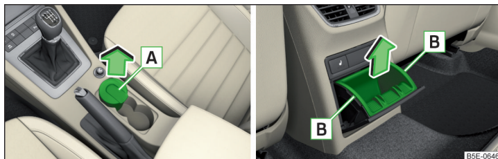
Fig. 94 Extragerea scrumierei față / extragerea corpului scrumierei spate
