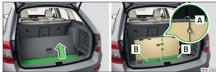
Fig. 111 Ridicați mocheta / compartimentele de depozitare de sub mocheta
