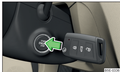
Fig. 131 Porniți motorul - apăsați butonul cu cheie.
