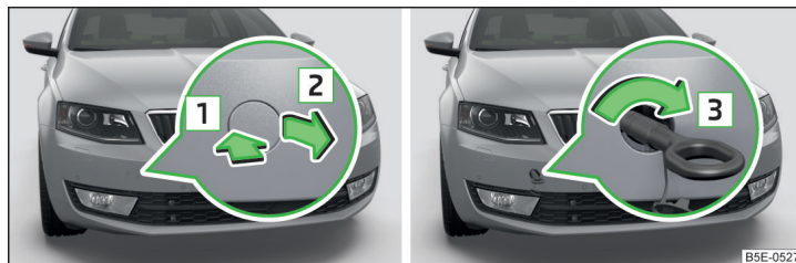
Fig. 208 Demontarea capacului / Montarea cârligului de tractare
