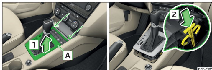
Fig. 216 Deblocarea de urgență a selectorului de viteze
