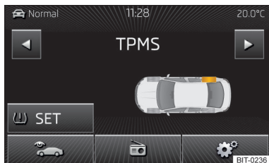
Fig. 164 Tasta pentru memorarea valorilor presiunii / exemplu de indicator de pe afișaj: sistemul atrage atenția asupra unei modificări a presiunii anvelopei din spate dreapta
