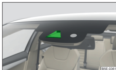
Fig. 162 Domeniul de vizibilitate al camerei pentru recunoașterea indicatoarelor din trafic
