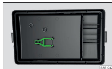
Fig. 223 Capac panou de siguranțe în compartimentul motor: Clemă de material plastic pentru siguranțe
