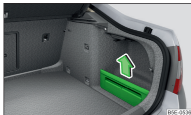
Fig. 109 Scoaterea compartimentului de depozitare
