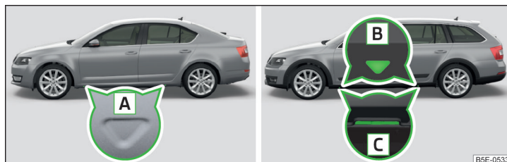
Fig. 201 Puncte pentru fixarea cricului: Varianta 1/variante 2
