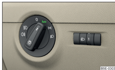
Fig. 52 Comutatorul de lumini: Poziția AUTO
