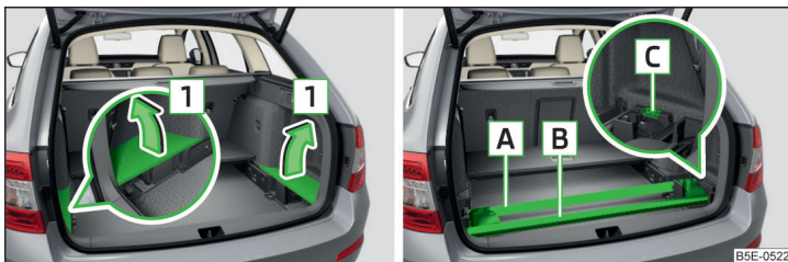
Fig. 121 Scoaterea capacelor laterale ale portbagajului / depozitarea suportului pentru portbagaj de acoperiș
