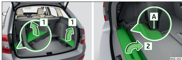
Fig. 108 Scoaterea capacelor laterale ale portbagajului / depozitarea capacului rulabil al portbagajului
