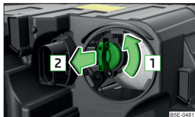
Fig. 226 Becul cu incandescentă pentru faza lungă, faza scurtă și lumina de poziție
