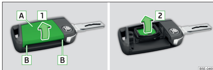
Fig. 211 Demontarea capacului / scoaterea bateriei
