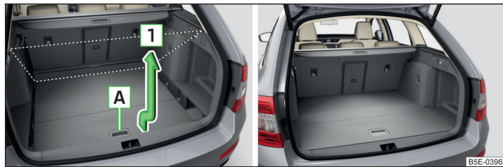
Fig. 113 Reglarea podelei variabile în poziția superioară / podea variabilă în poziție superioară
