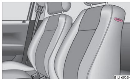
Fig. 126 Locul de amplasare al airbag-ului lateral în scaunul conducătorului
