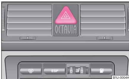
Fig. 49 Tabloul de bord: Înterupător pentru instalația de avertizare avarie
