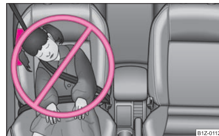
Fig. 131 Copil neasigurat corect într-o poziție incorectă - siguranța periclitată de airbag-ul lateral
