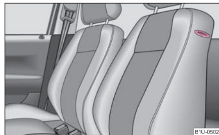
Fig. 121 Locul de amplasare al airbagului lateral în scaunul conducătorului
