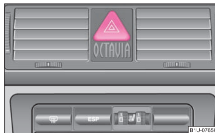
Fig. 44 Tabloul de bord: Înterupător pentru instalația de avertizare avarie
