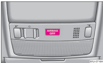
Fig. 124 Lampa de control pentru deconectarea airbagului pasagerului din dreapta
