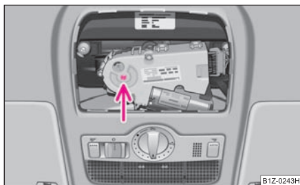
Fig. 39 Imagine din plafon: Acționarea în caz de urgență
