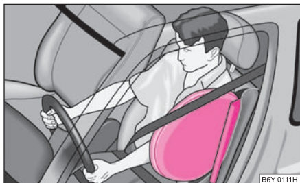
Fig. 122 Airbaguri laterale umplute cu gaz
