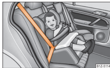
Fig. 106 Scaun cu măsuta de siguranță din grupa 1 montat pe bancheta din spate, cu fața la sensul de mers.
