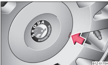
Fig. 136 Scoaterea ornamentului de roată la jantele din metal ușor
