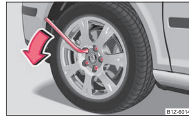
Fig. 137 Înlocuirea roții: Slăbirea șuruburilor de roți
