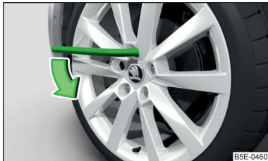
Fig. 152 Înlocuirea roții: Slăbirea șuruburilor de roată
