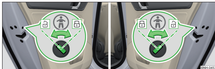
Fig. 38 Portiera spate: Activarea/dezactivarea siguranței pentru copii
