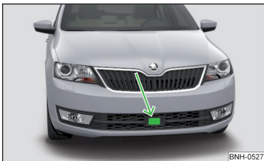
Fig. 115 Locul de amplasare al senzorului radar
