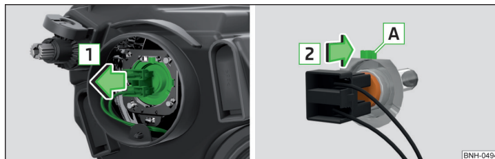
Fig. 173 Înlocuirea becului luminii de întâlnire
