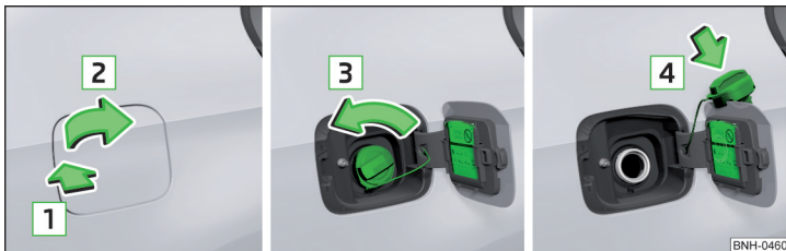
Fig. 134 Deschiderea clapetei rezervorului de combustibil/Deșurubarea bușonului rezervorului de combustibil/Introducerea bușonului rezervorului de combustibil în clapeta rezervorului de combustibil
