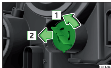
Fig. 176 Înlocuirea becului luminii de semnalizare față
