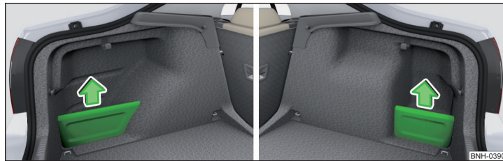
Fig. 92 Detașarea capacului compartimentului de depozitare stânga/dreapta
