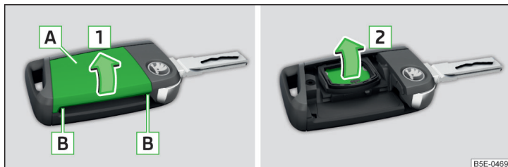
Fig. 170 Demontarea capacului/scoaterea bateriei
