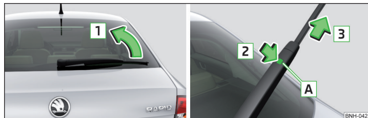
Fig. 177 Înlocuirea lamelei ștergătorului de lunetă
