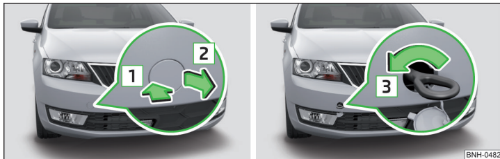
Fig. 168 Scoaterea capacului/montarea cârligului de tractare
