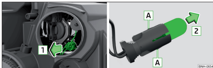
Fig. 187 Înlocuirea becului luminii de poziție
