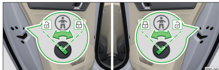
Fig. 34 Portiera spate: Activarea/dezactivarea siguranței pentru copii
