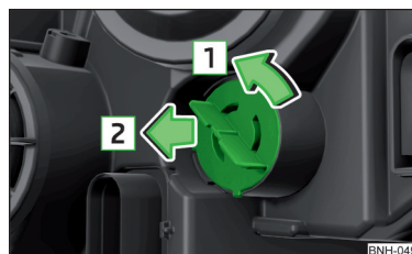
Fig. 188 Înlocuirea becului luminii de semnalizare față
