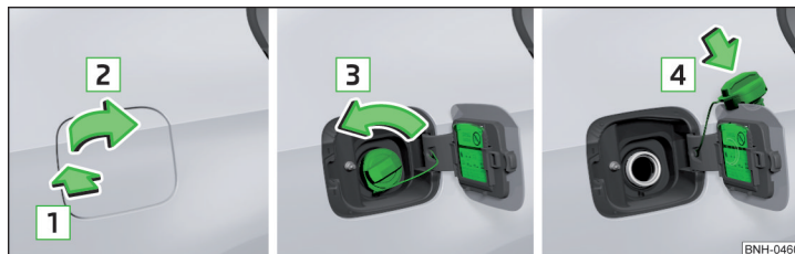
Fig. 144 Deschiderea clapetei rezervorului de combustibil/Deșurubarea bușonului rezervorului de combustibil/Introducerea bușonului rezervorului de combustibil în clapeta rezervorului de combustibil
