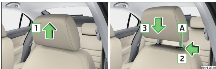
Fig. 57 Reglarea pe înălțime a tetierei
