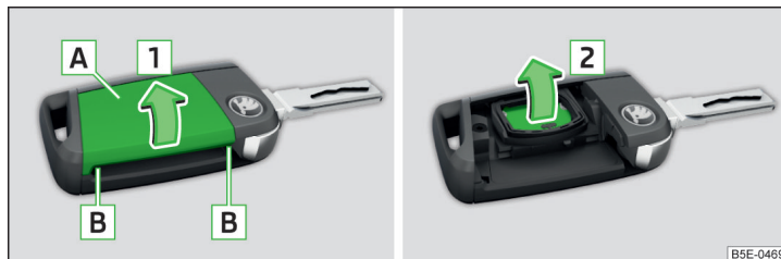
Fig. 255 Ridicarea capacului/scoaterea bateriei
