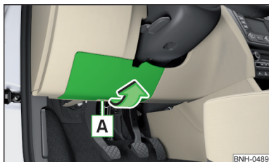
Fig. 264 Detășarea capacului panoului de siguranțe
