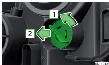
Fig. 273 Înlocuirea becului luminii de semnalizare față
