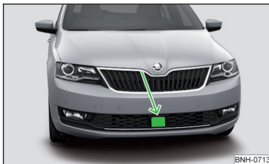
Fig. 194 Locul de montare al senzorului radar
