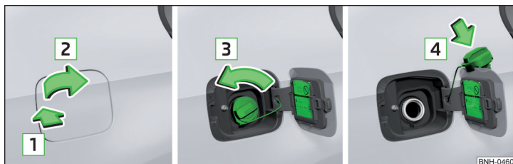
Fig. 229 Deschiderea clapetei rezorului de combustibil/Deșurubarea bușonului rezorului de combustibil/Introducerea bușonului rezorului de combustibil în clapeta rezorului de combustibil
