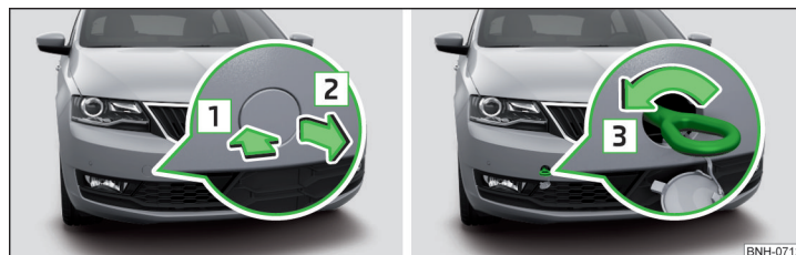
Fig. 253 Scoaterea capacului/montarea cârligului de tractare
