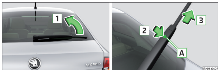
Fig. 262 Înlocuirea lamei ștergătorului de lunetă
