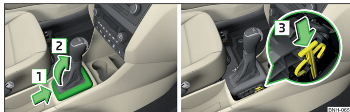
Fig. 259 Scoaterea capacului/deblocarea selectorului de viteze
