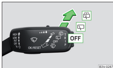
Fig. 68 Operarea instalației de ștergere și spălare a geamurilor
