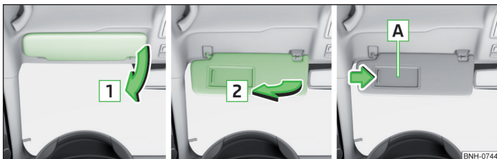
Fig. 61 Rabatarea înspre în jos a măștii/rabaterea înspre în sus a măștii/oglindea pentru machiaj
