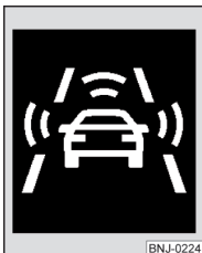
Fig. 206 Afșișajul panoului de bord: Preavertizare, resp. frânare de urgență la o viteză redusă
