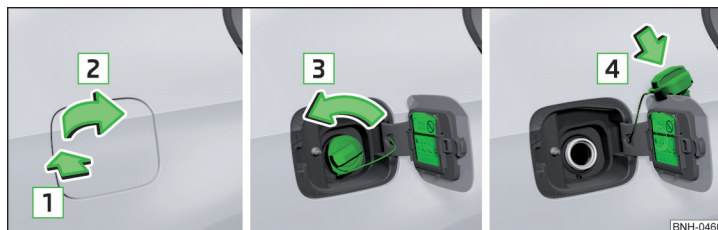
Fig. 223 Deschiderea clapetei rezervorului de combustibil/Deșurubarea bușonului rezervorului de combustibil/Introducerea bușonului rezervorului de combustibil în clapeta rezervorului de combustibil
