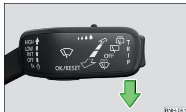
Fig. 253 Reglarea poziției de service a brațelor ștergătoarele de parbriz
