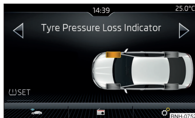
Fig. 208 Tasta pentru memorarea valorilor presiunii/exemplu de indicator de pe afișaj: sistemul atrage atenția asupra unei modificări a presiunii anvelopei din dreapta față
