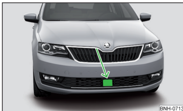
Fig. 190 Locul de montare al senzorului radar
